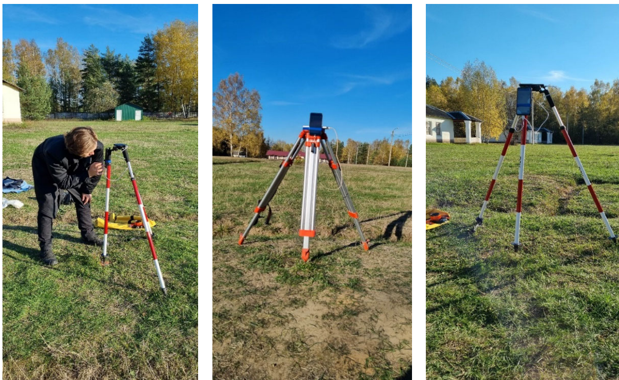
Рис. 1 Установка кодового ГНСС-приемника мобильного телефона над центром пункта геодезической сети.
