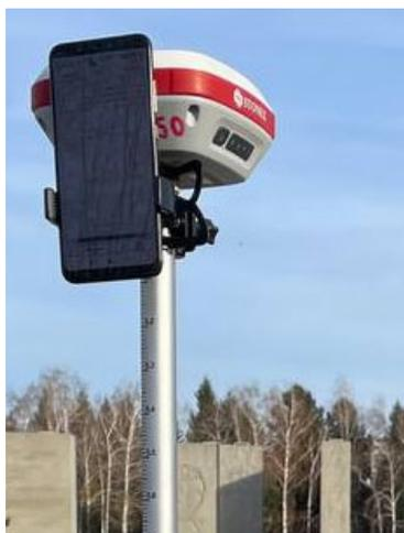
Рис. 4. Экспериментальная установка для получения синхронных измерений со смартфона и приемника
