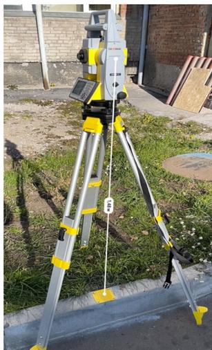
Рис.3. Измерений высоты инструмента с помощью приложения «Рулетка».
