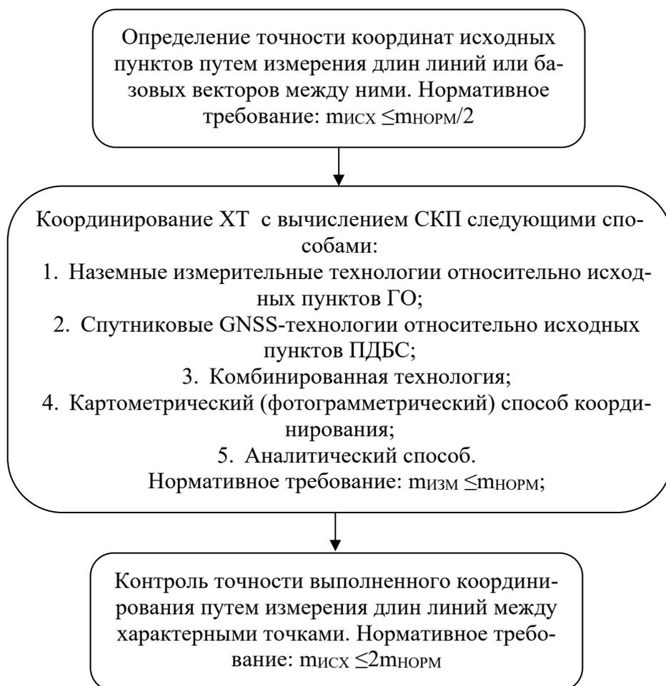
Рисунок 2 – Технологическая схема геодезического обеспечения кадастровых работ
