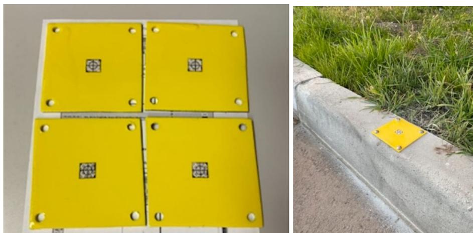
Рис. 3 Специальные пластины с отражательными пленками
