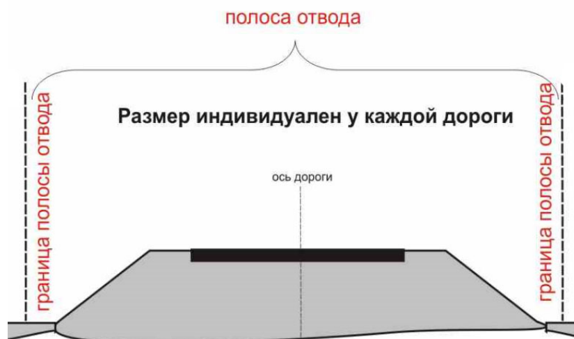
Рис. 2. Полоса отвода автомобильной дороги
