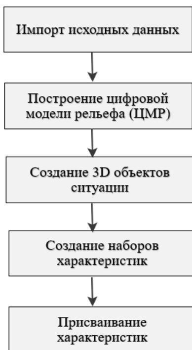
Рис.1. Технологическая схема создания BIM-моделей объектов ситуации
