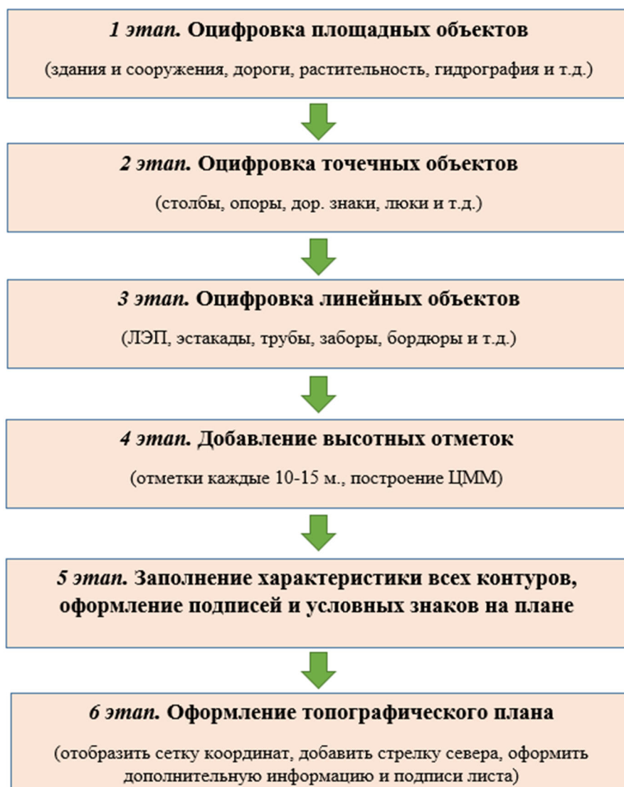
Рис. 7. Технологическая схема выполнения топографического картографирования застроенной территории по ортофотоплану масштаба 1:500
