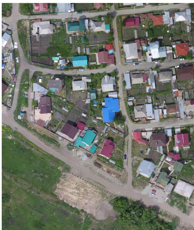
Рис. 3. Ортофотоплан, полученный в результате обработки цифровых макетных снимков
