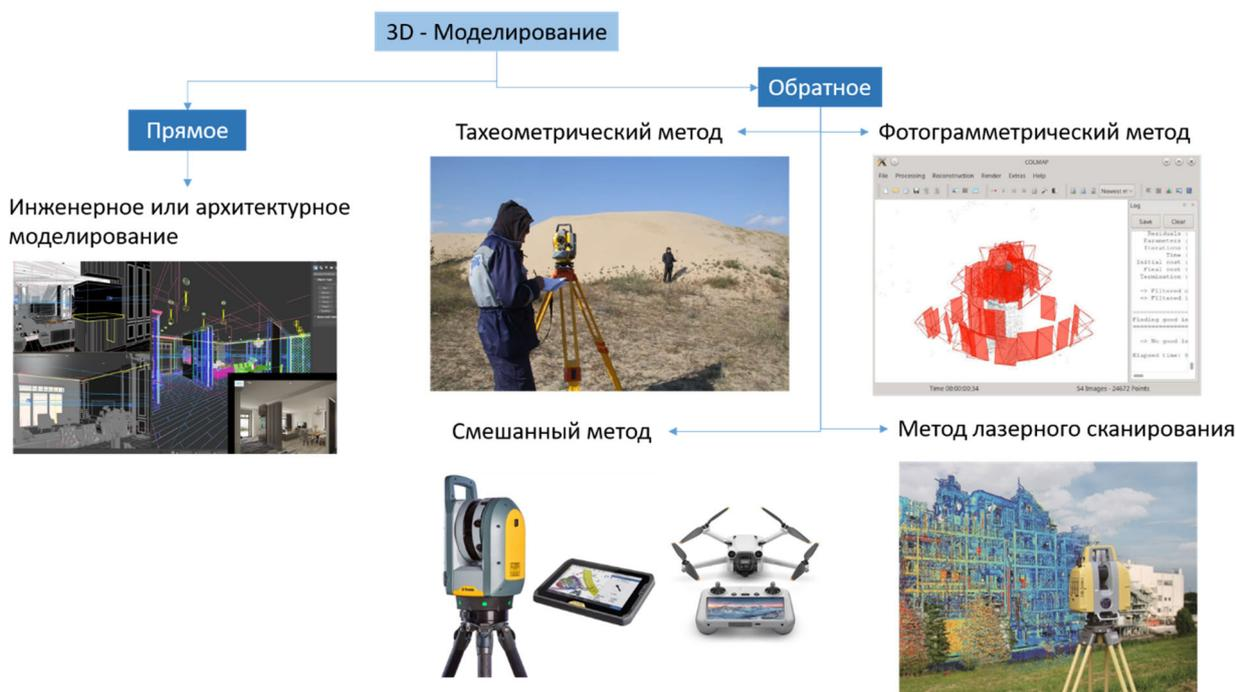
Рис. 1. Методы 3D моделирования
