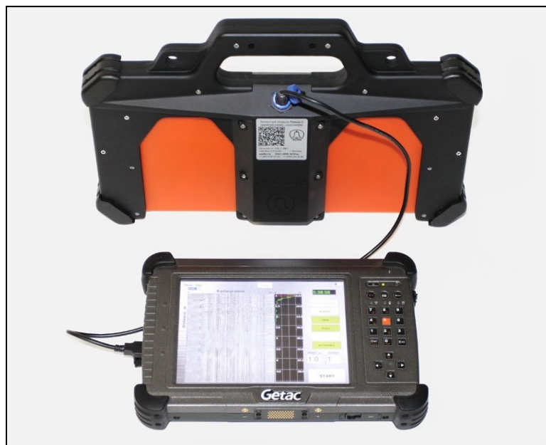
Рис. 2 – георадар «Пикор-Лёд» в комбинации с планшетом
