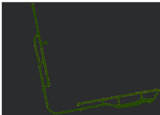
Рис.2. Облако точек аэропортового комплекса, вид сверху
