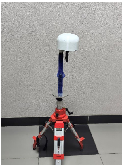
Рис. 2. Компактная чок - ринг антенна с защитным куполом
