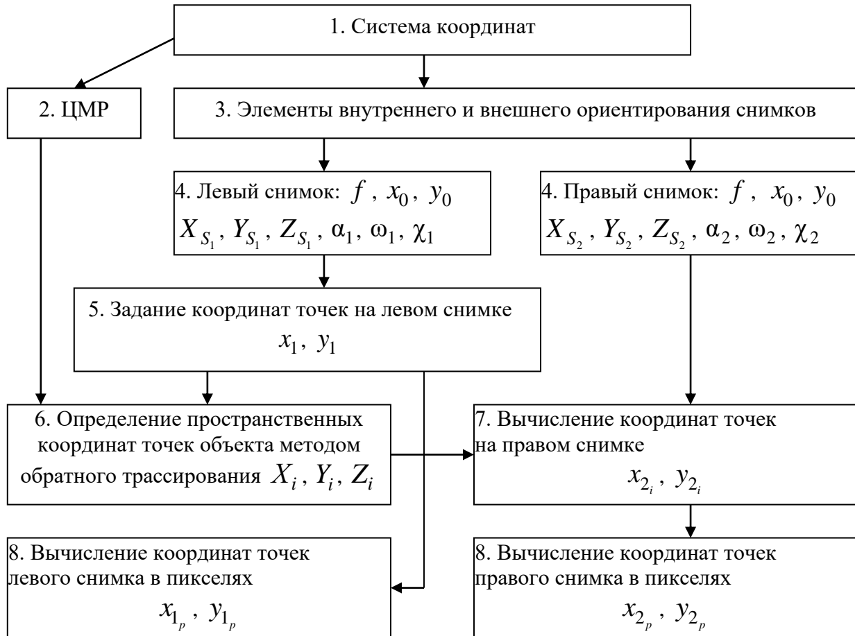
Рисунок 1 – Принципиальная схема методики моделирования стереопары непрерывных макетных снимков
