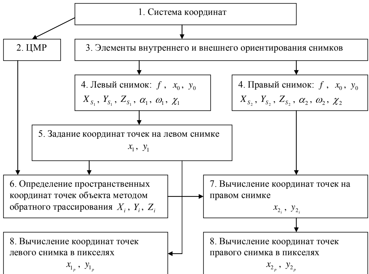
Рисунок 11 – Принципиальная схема методики формирования стереопары аналитических непрерывных макетных снимков
