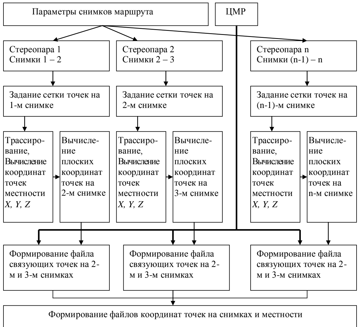
Рисунок 13 – Алгоритм формирования маршрута аналитических макетных снимков
