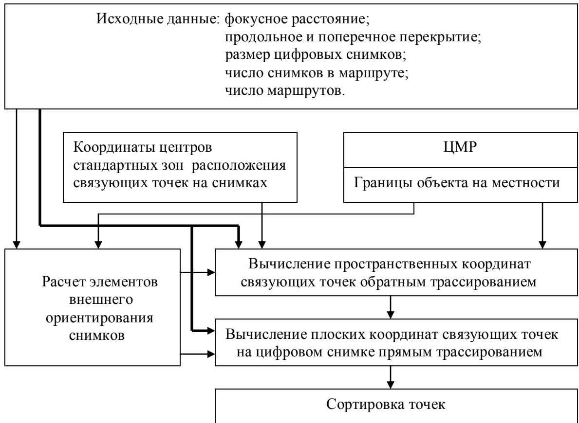
Рисунок 16 – Алгоритм формирования аналитических непрерывных макетных снимков блока
