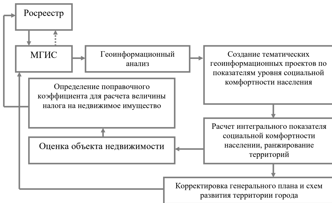
Рисунок 12 – Последовательность технологических операций при анализе, оценке и управлении территорией на основе интегрального показателя социальной комфортности
