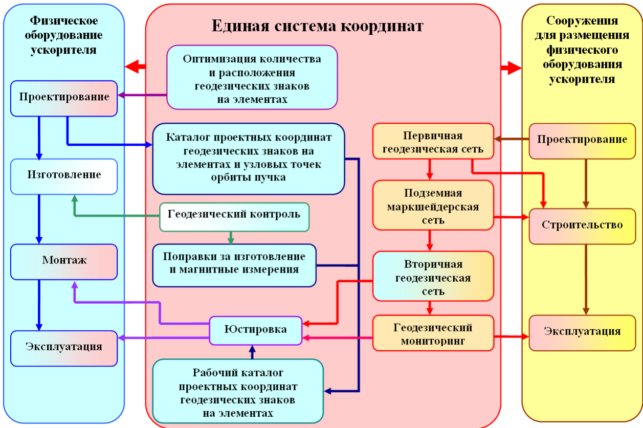
Рисунок 1 – Структурная схема геодезического обеспечения стадий создания УНК с учетом технологических связей
