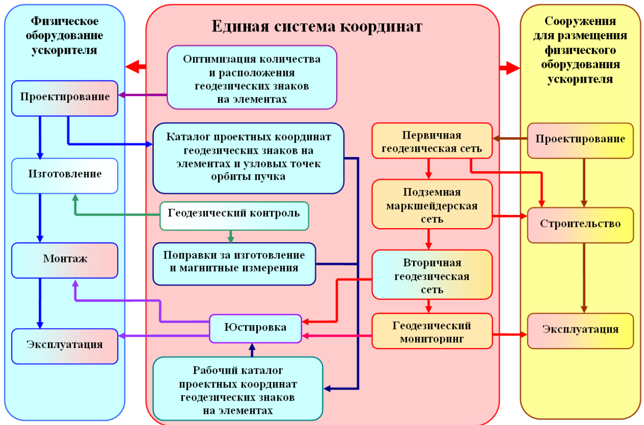
Рисунок 2.1 – Структурная схема геодезического обеспечения этапов создания УНК с учётом технологических связей
