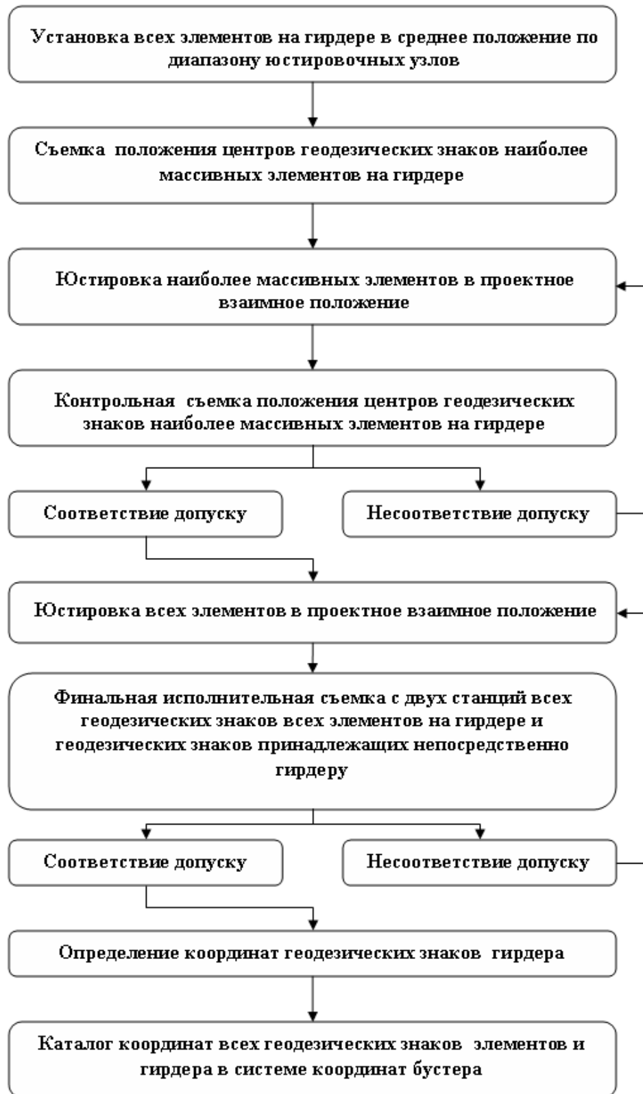
Рисунок 2.8 – Схема геодезического сопровождения сборки модулей бустера
