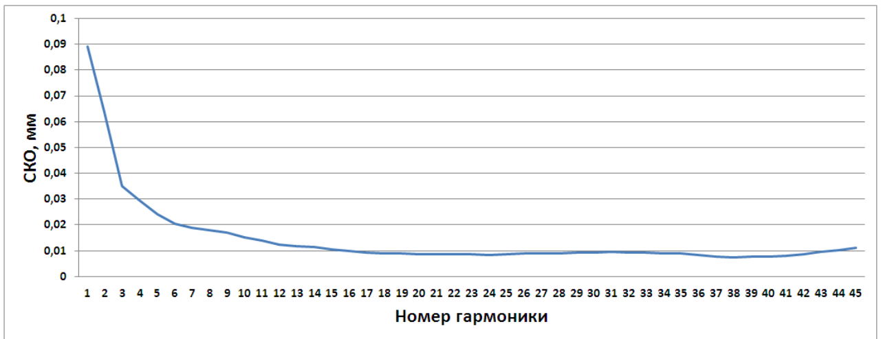
Рисунок 3.16 – Точность определения величины амплитуд гармоник
