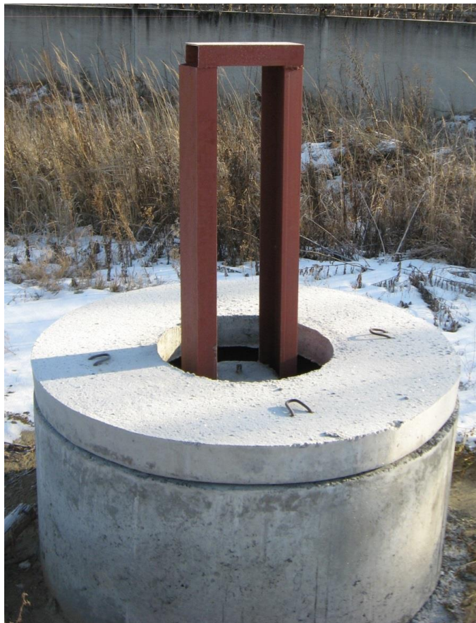
Рисунок 3.4 – Общий вид наземных геодезических пунктов сети
