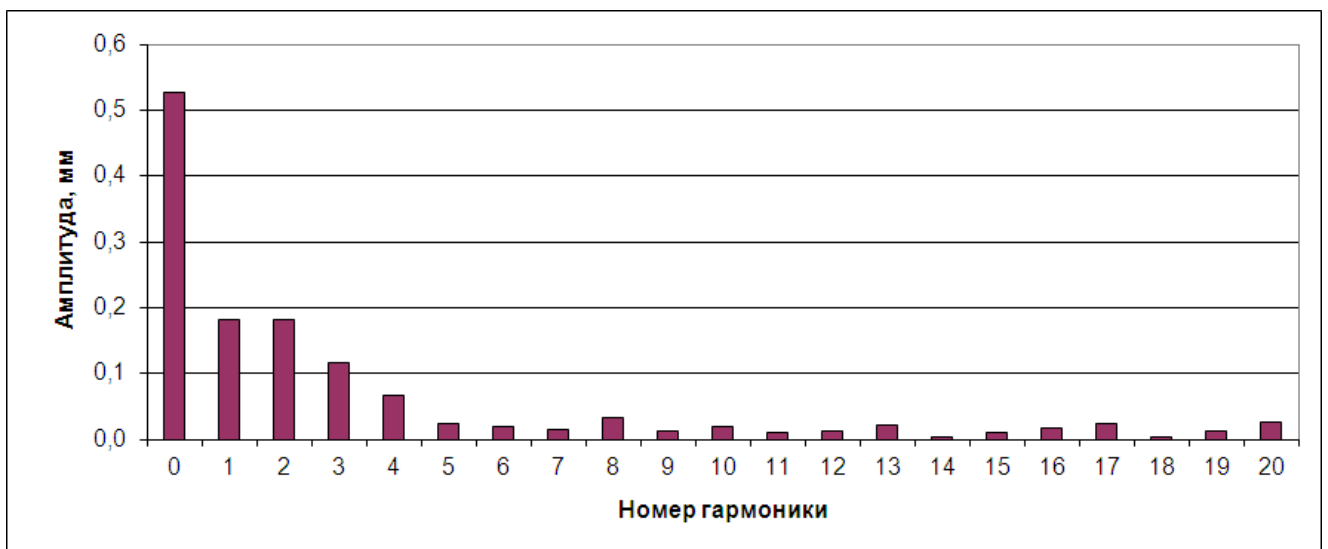
Рисунок 2.16 – Спектральный состав погрешностей определения плановых координат во вторичной сети бустера NSLS-II
