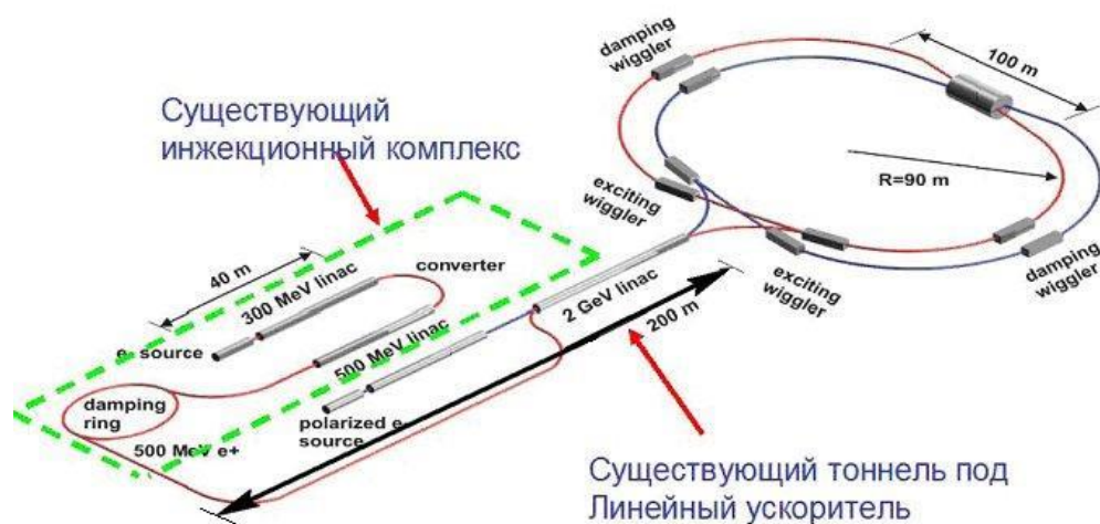
Рисунок 1.3 – Схема комплекса ВЭПП-5
