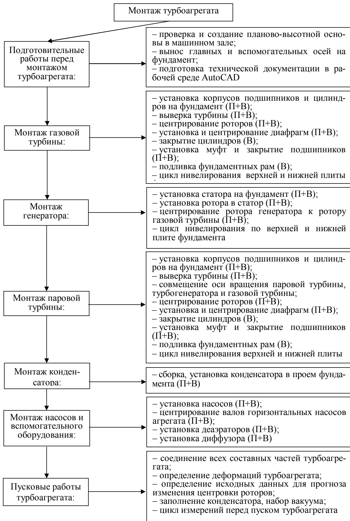
Рисунок 3 – Технологическая схема монтажа турбоагрегата
