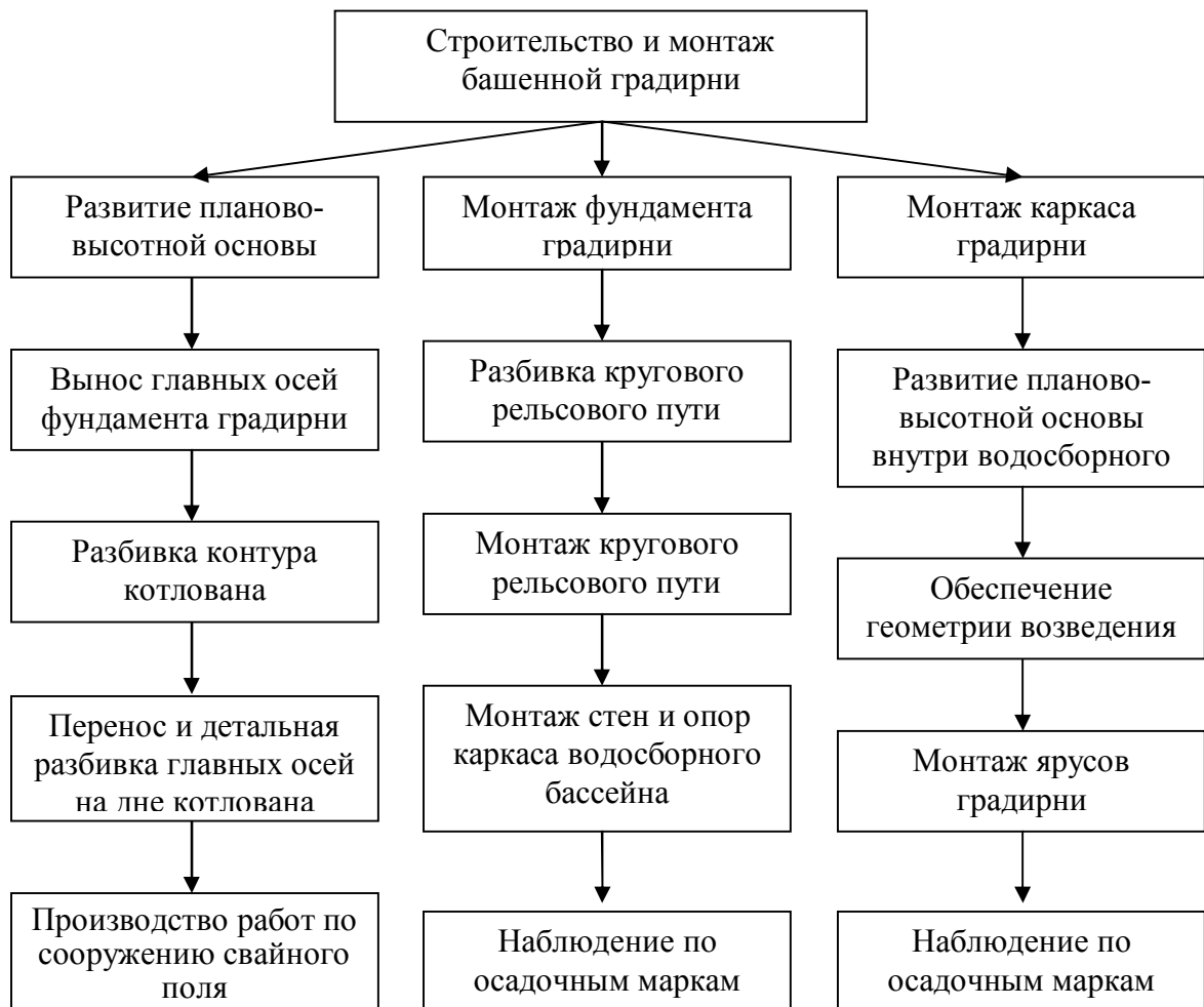
Рисунок 3.2 – Состав инженерно-геодезических работ при строительстве градирни
