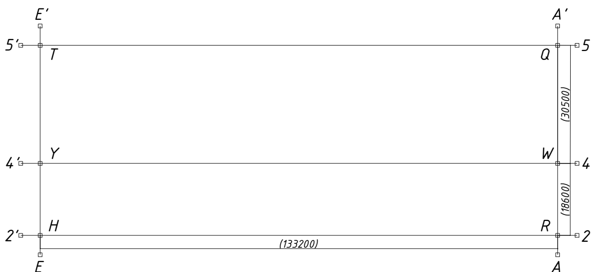
Рисунок 2.18 – Схема выноса габаритных осей
