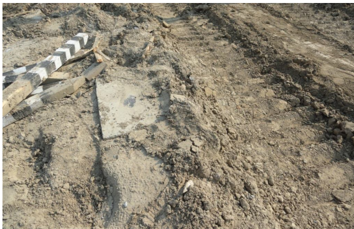
Рисунок 2.4 – Внешний вид ПСС после наезда гусеничной техники
