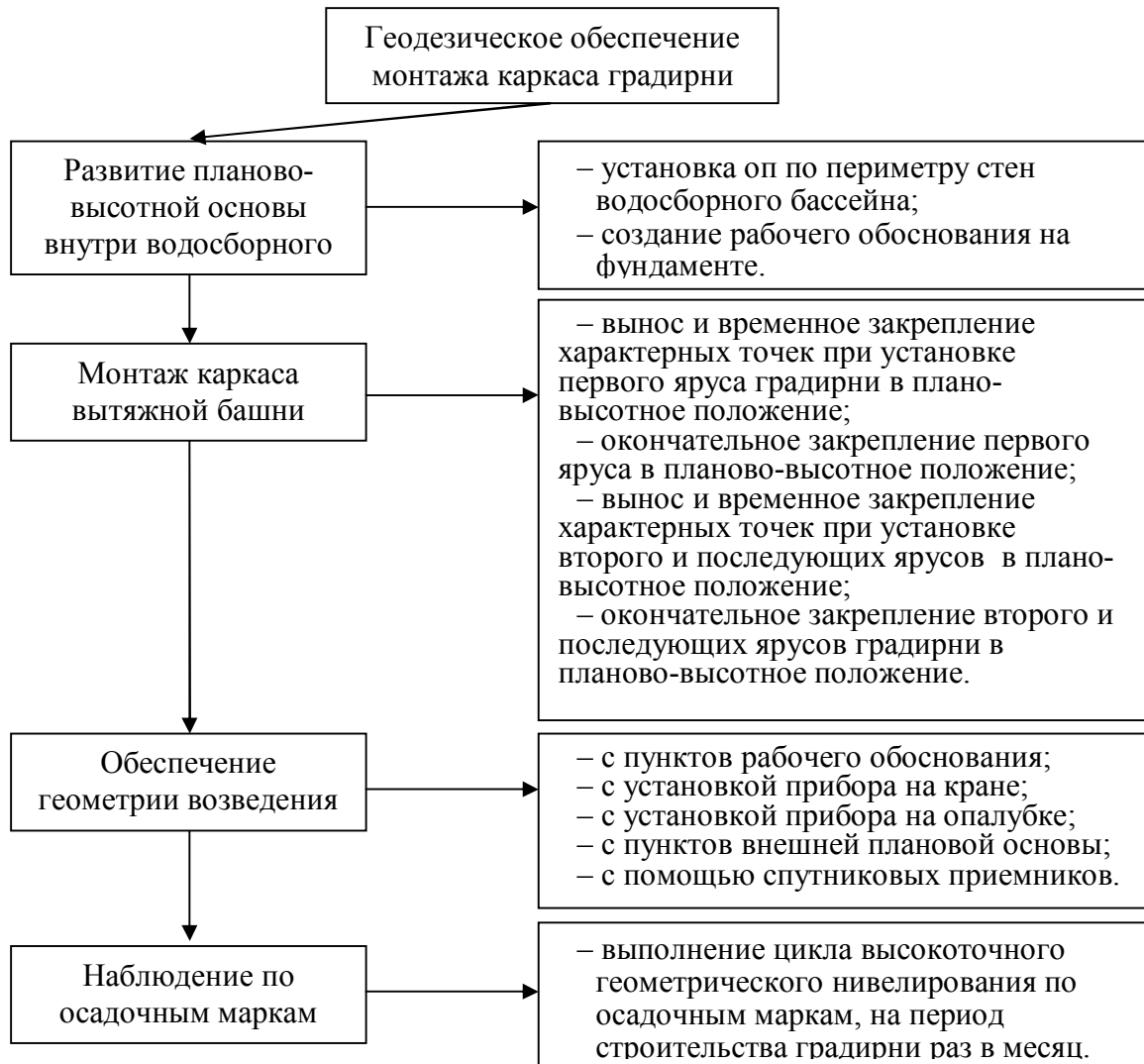
Рисунок 3.10 – Технологическая схема геодезического обеспечения монтажа металлического каркаса градирни
