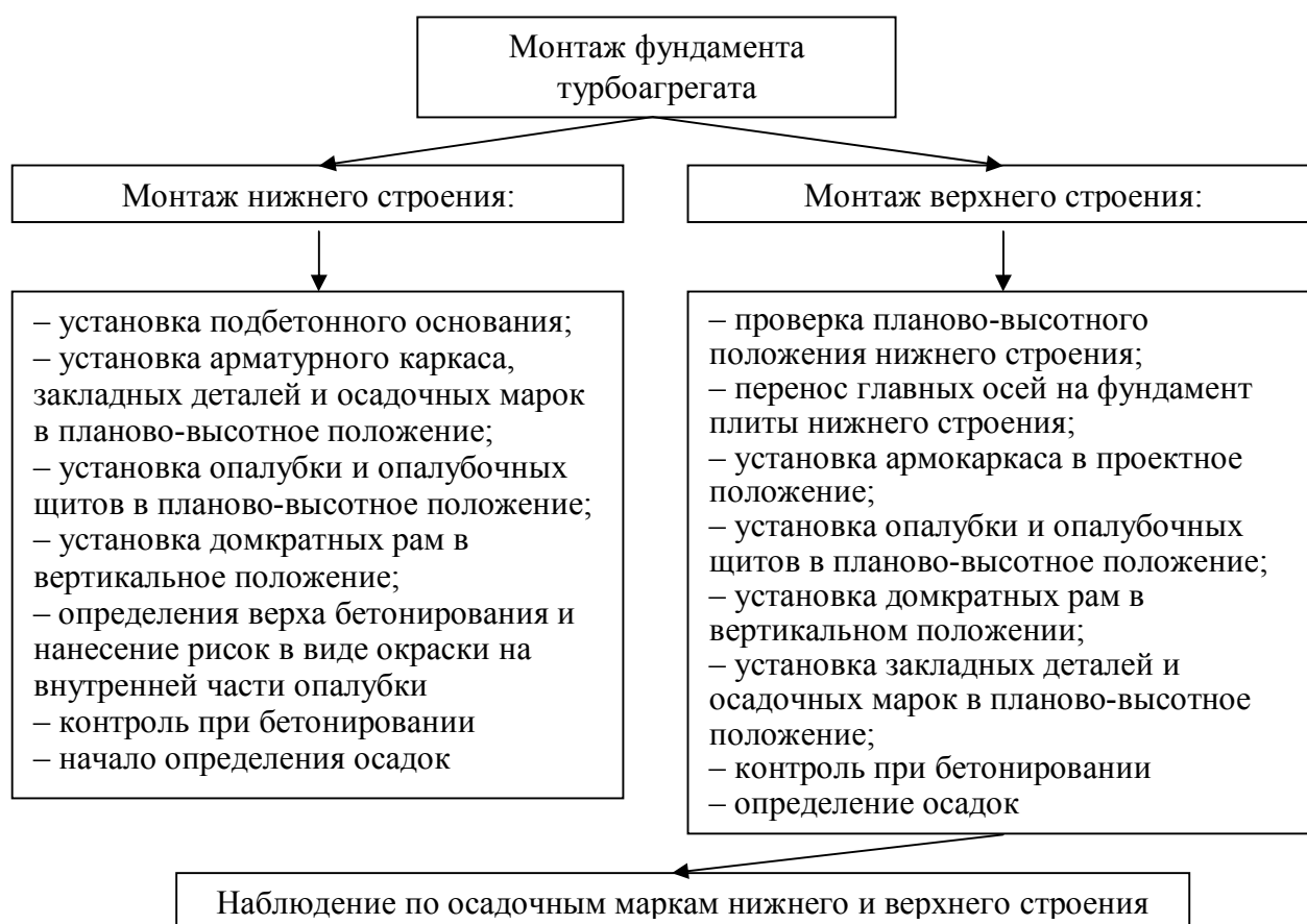
Рисунок 2.24 – Технологическая схема монтажа фундамента турбоагрегата
