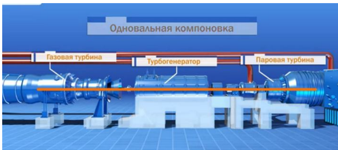
Рисунок 2.14 – Схема одновальной компоновки оборудования
