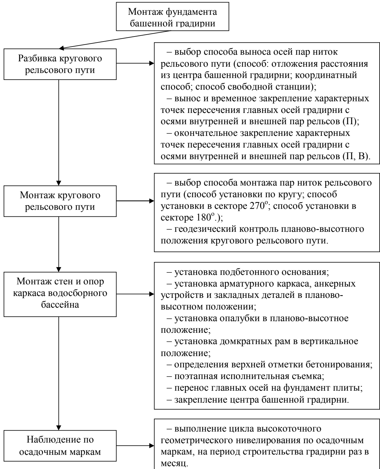
Рисунок 3.5 – Технологическая схема монтажа фундамента башенной градирни
