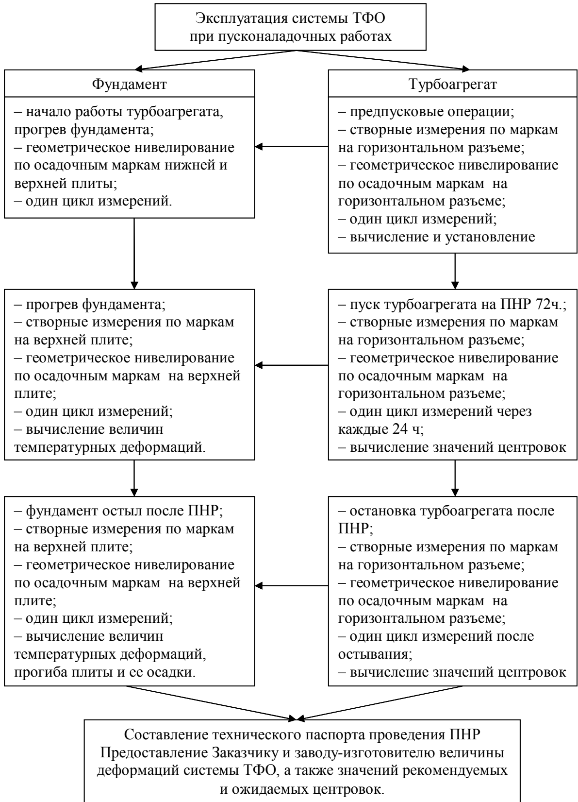
Рисунок 2.35. – Технологическая схема геодезического обеспечения при пусконаладочных работах системы ТФО
