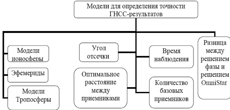
Рисунок 1 – Вариант структурной схемы изучения влияния указанных факторов на точность ГНСС-результатов
