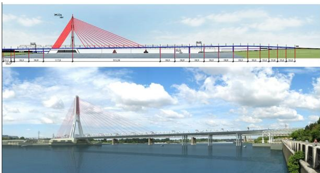
Рисунок 3 – Проект следующего вантового моста в Новосибирске
