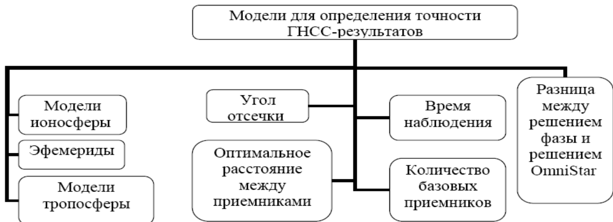
Рисунок 11– Вариант структурной схемы изучения влияния факторов на точность ГНСС
