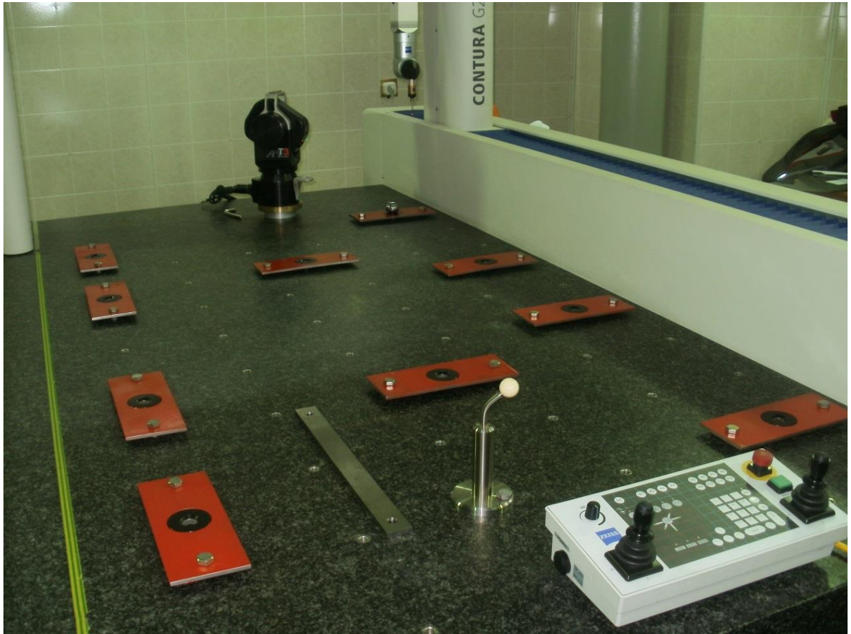
Рисунок 2.26 – Геодезические знаки, закрепленные на плите
