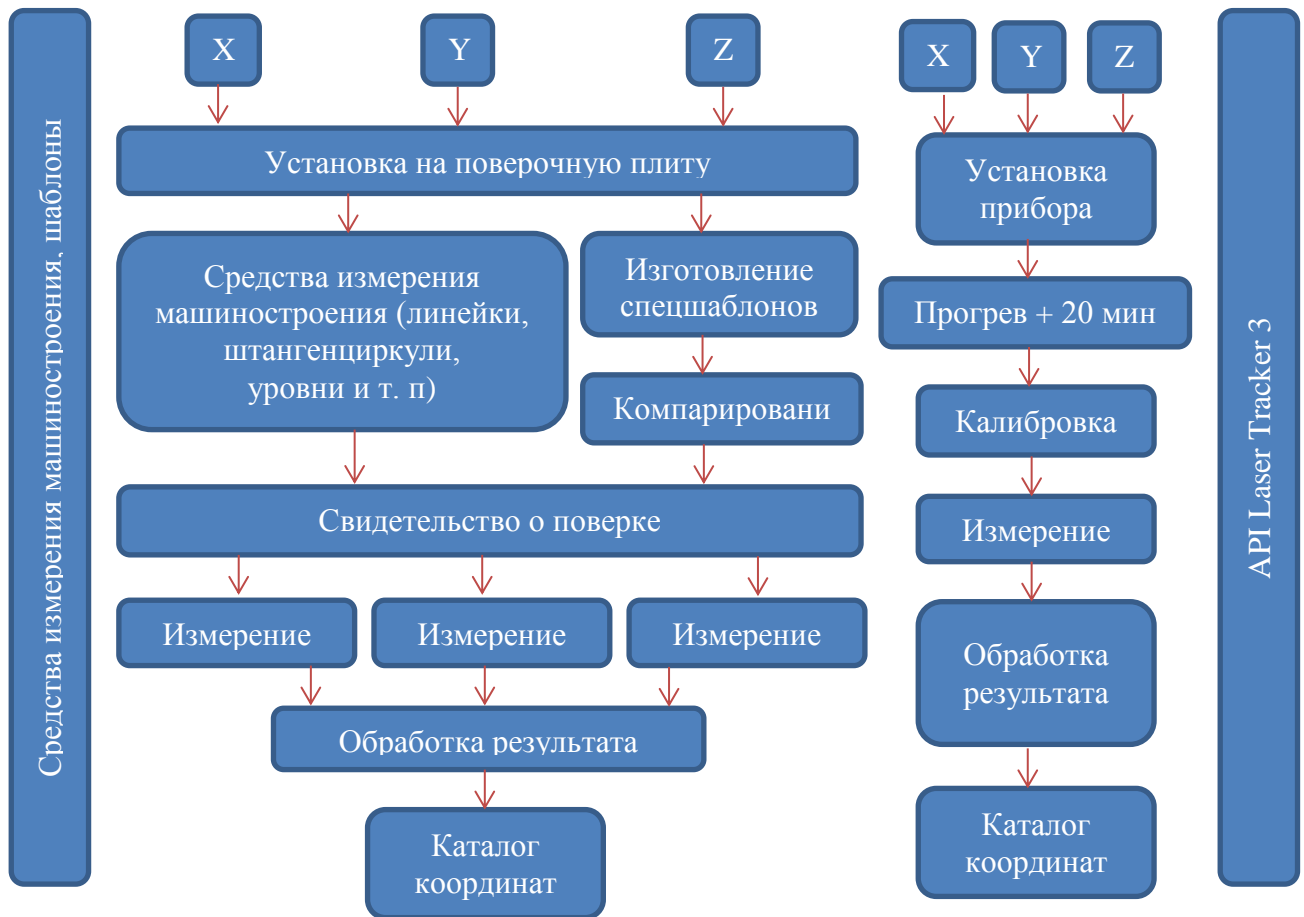
Рисунок 3.1 – Сравнение методик геодезических измерений
