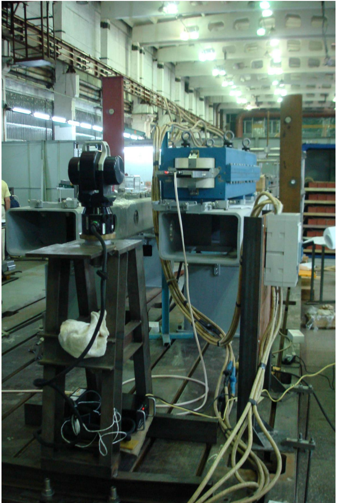
Рисунок 3.13 – Закрепление лазерного трекера на стенде магнитных измерений
