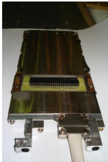
Рисунок 3.9 – Каретка с датчиками Холла и отражателями
