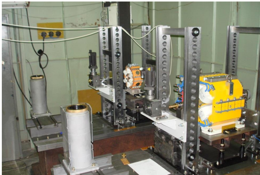
Рисунок 3.17 – Стапеля с квадруполем (ближний стапель) и секступолем (дальний стапель)
