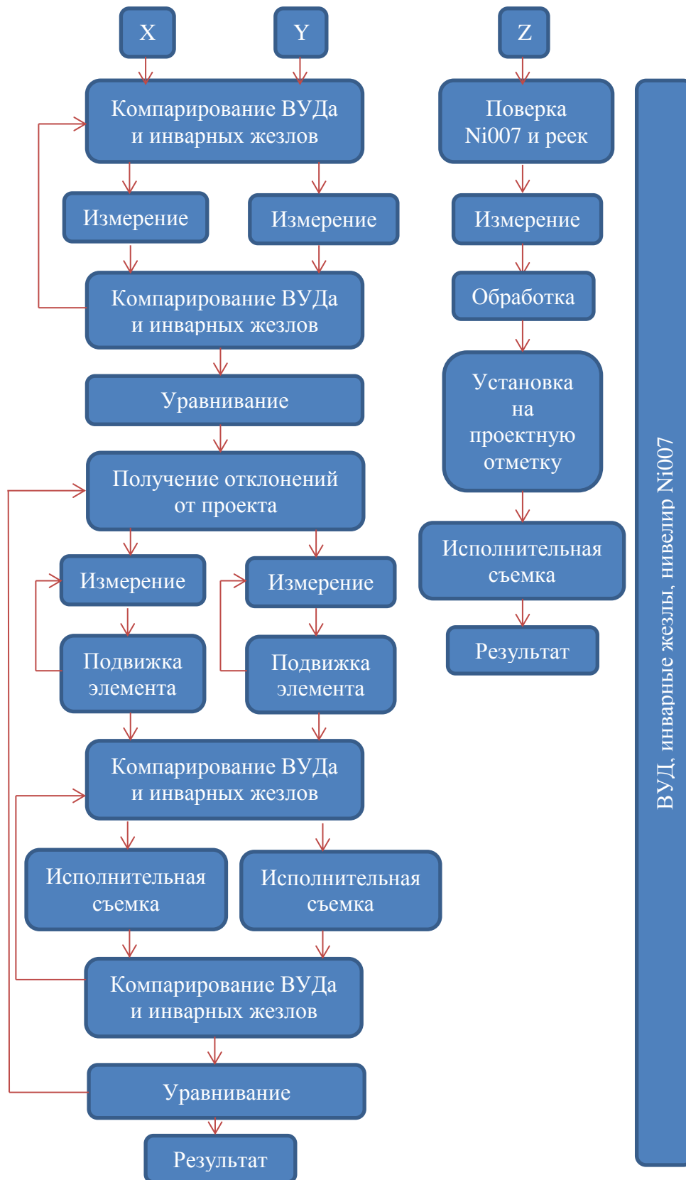
Рисунок 3.20 – Устаревшая методика установки комплекса ВЭПП-2000 в проектное положение
