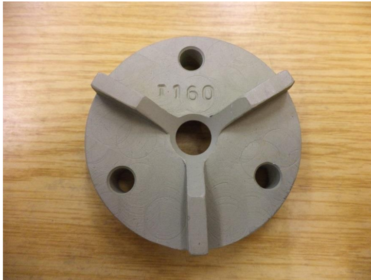
Рисунок 2.29 – Настенный геодезический знак под отражатель для лазерного трекера конструкции ИЯФ
