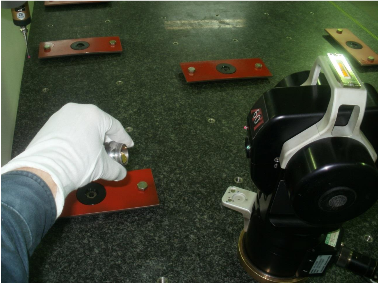
Рисунок 2.25 – API Laser Tracker 3 закрепленный на плите
