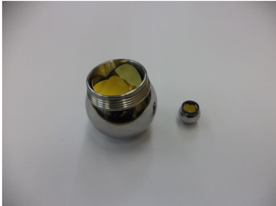
Рисунок 2.8 – Стандартный отражатель для лазерного трекера
