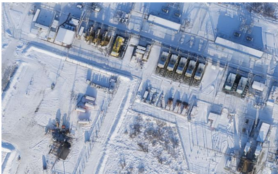
Рисунок А.1 – Ортофотоплан М 1 : 1 000 с разрешением 5 см/пиксель на территорию электросетевого комплекса
