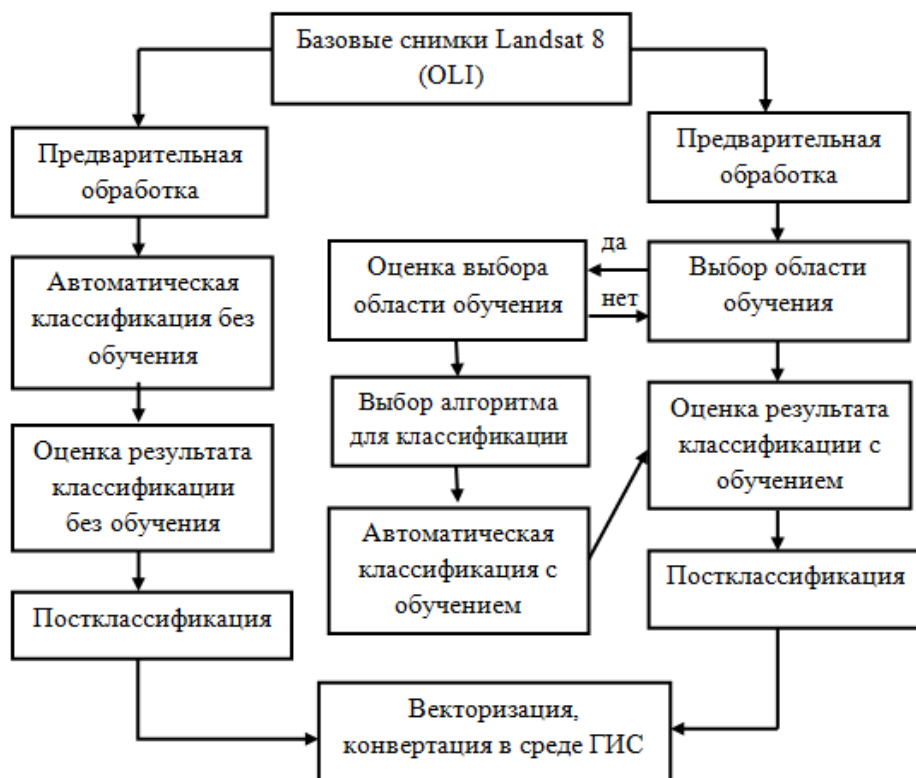
Рисунок 2 – Технологическая схема выполнения автоматической классификации космических снимков
