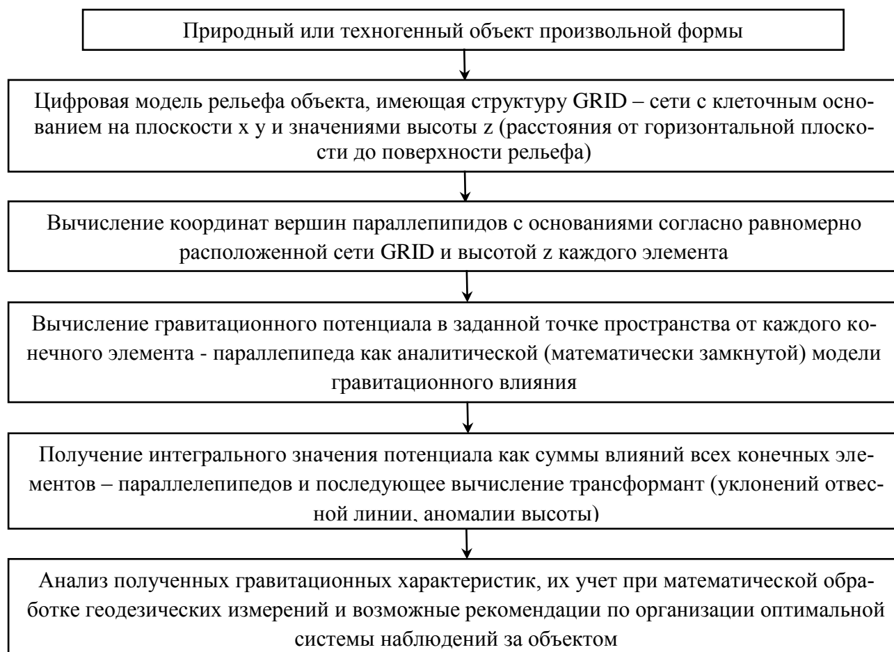
Рисунок 34 – Общая схема алгоритма аппроксимации гравитационного влияния конуса, как суммы влияний конечных элементов – вытянутых параллелепипедов
