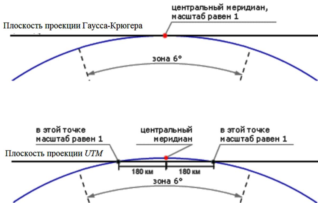
Рисунок 1 – Различие между проекциями Гаусса-Крюгера и UTM (Гаусса-Боага)
