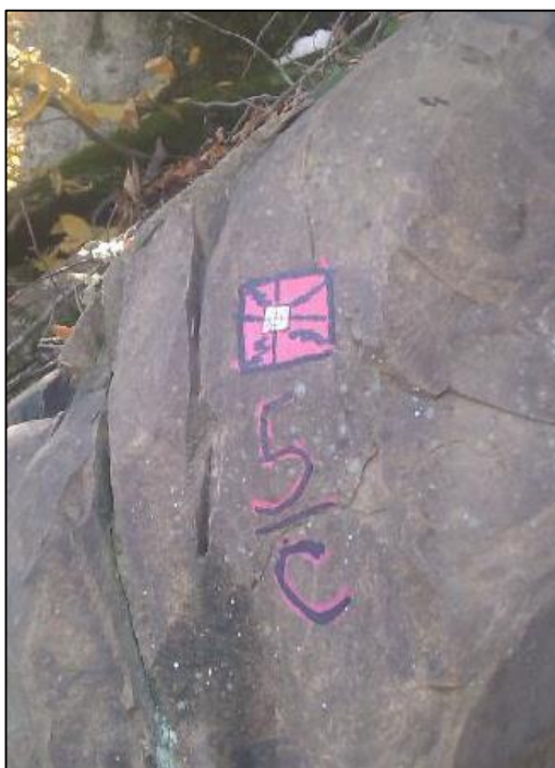
Рисунок 5 – Закрепление пункта ГРО на скале
