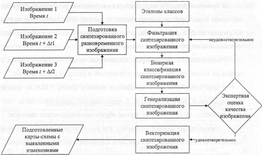
Рисунок 2 – Алгоритм обработки комбинаций разновременных космических снимков для выявления изменения на лесных землях
