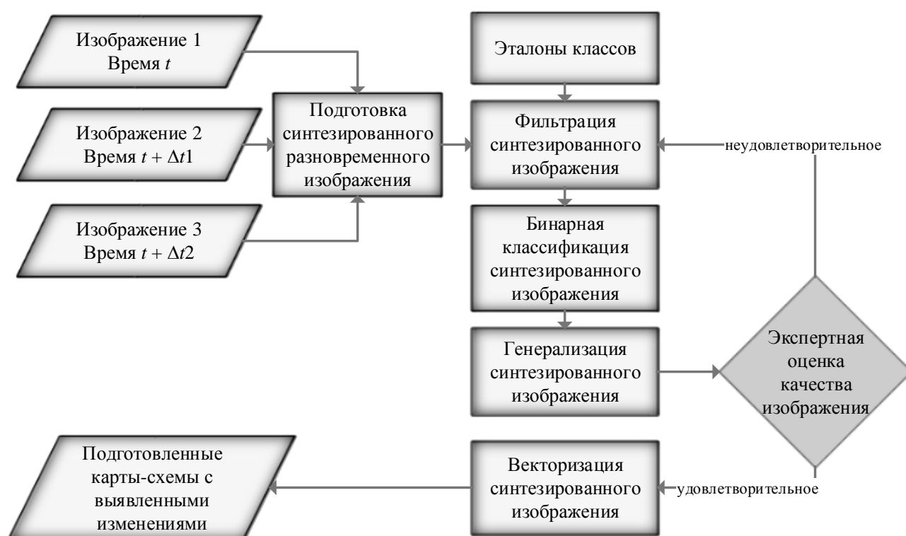
Рисунок 3.3 – Алгоритм обработки комбинаций разновременных космических снимков для выявления изменений на лесных землях
