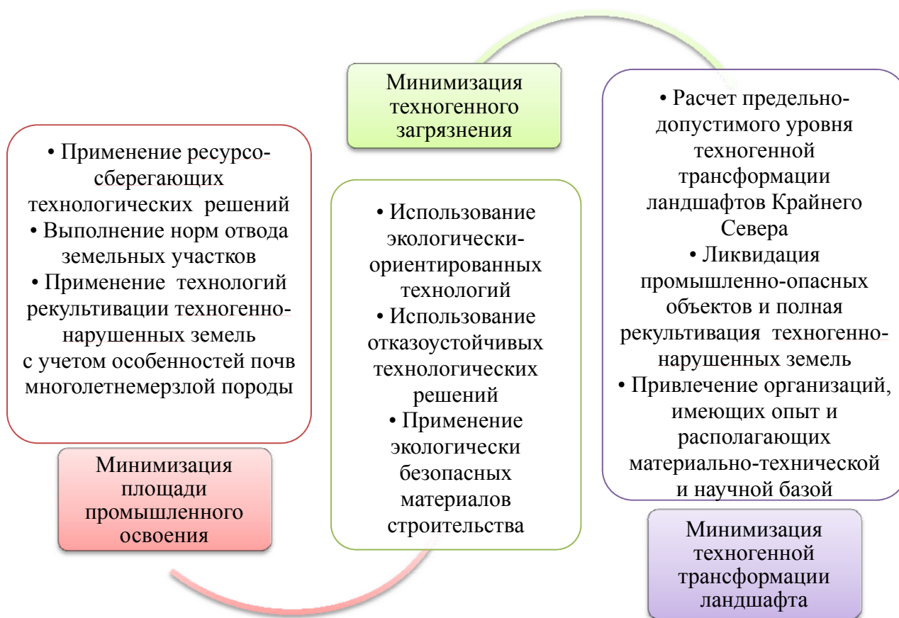
Рисунок 2 – Критерии минимизации ущерба землепользованиям от промышленного освоения с учетом региональных особенностей земель Крайнего Севера
