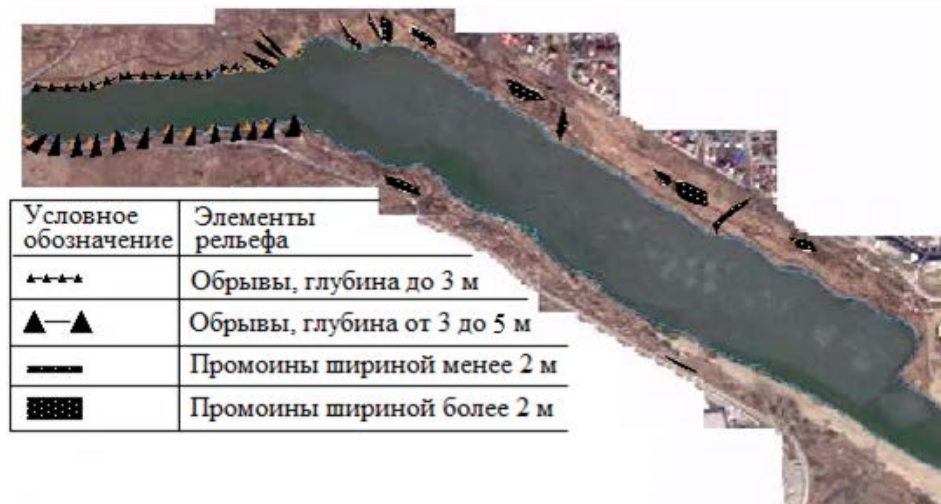
Рисунок 3.5 – Схема и условные обозначения обрывов и промоин в пределах береговой полосы обводненного карьера
