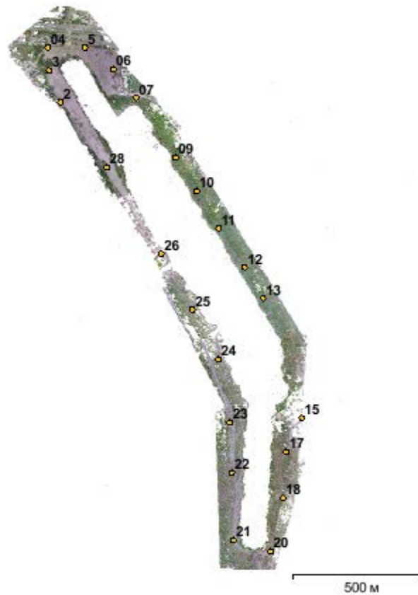
Рисунок Г.4 – Позиции опорных точек
