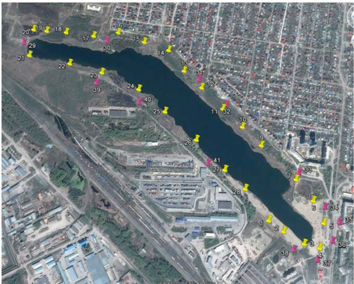
Рисунок 3.14 – Схема расположения опорных и контрольных точек
