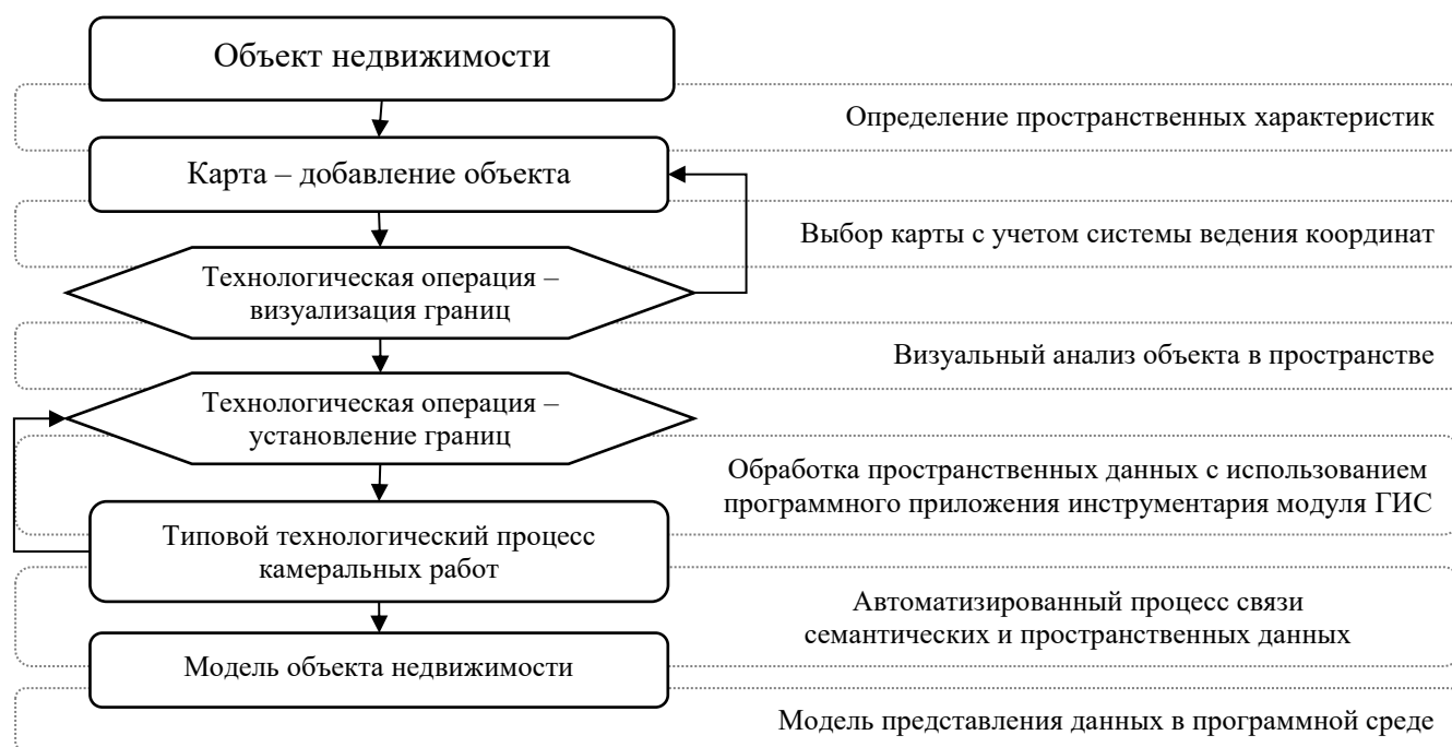
Рисунок 25 – Алгоритм кадастровых работ в модуле АРМ ГИС
