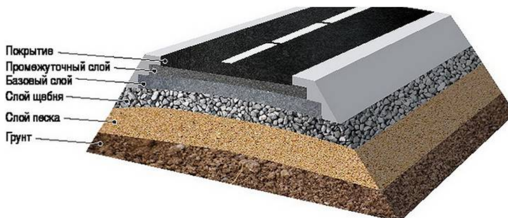
Рисунок 4.11 – Конструктивные слои автомобильной дороги
