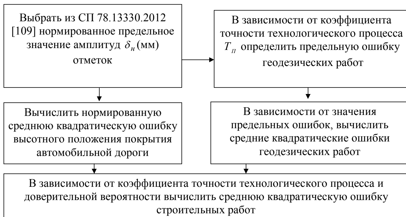
Рисунок 2.2 – Схема расчета средних квадратических ошибок геодезических и строительных работ с учетом точности технологических процессов
