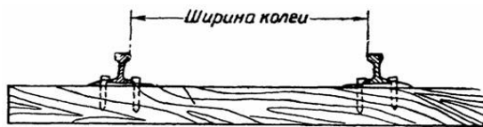
Рисунок 3 – Схема измерения ширины колеи
