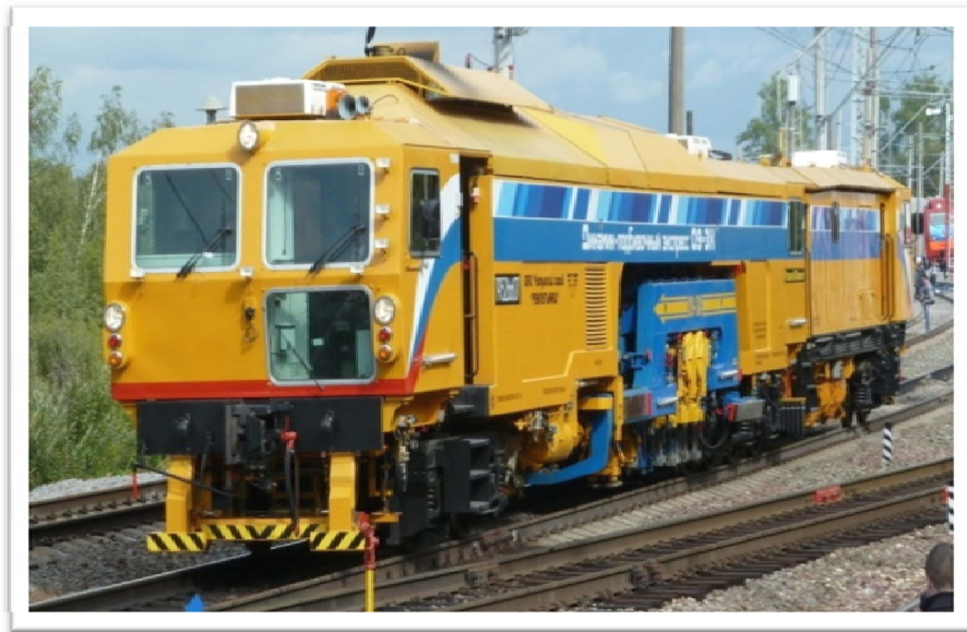
Рисунок 46 – Выправочно-рихтовочно-подбивочная машина, оборудованная САУ-3D (ГНСС)
