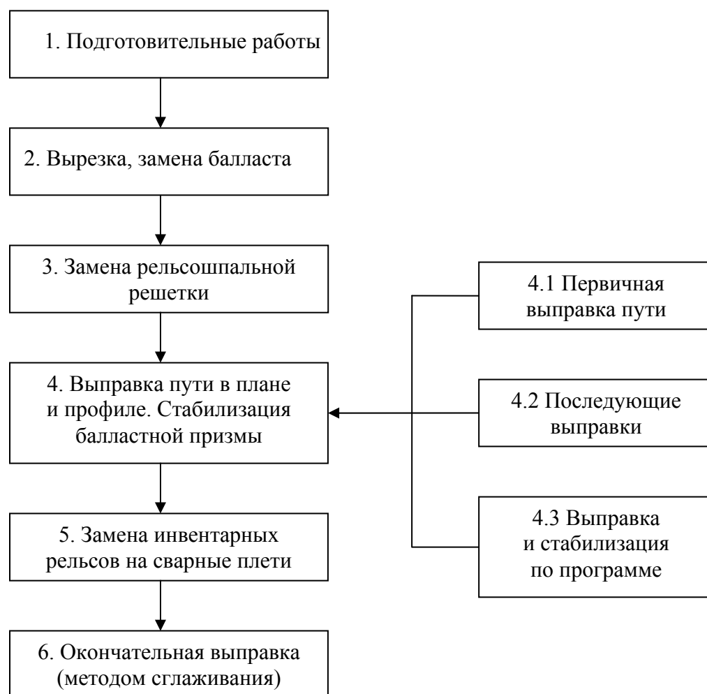
Рисунок 1 – Структурная схема технологии реконструкции верхнего строения пути (РВСП) и капитального ремонта
