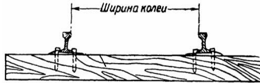
Рисунок 9 – Схема измерения ширины колеи
