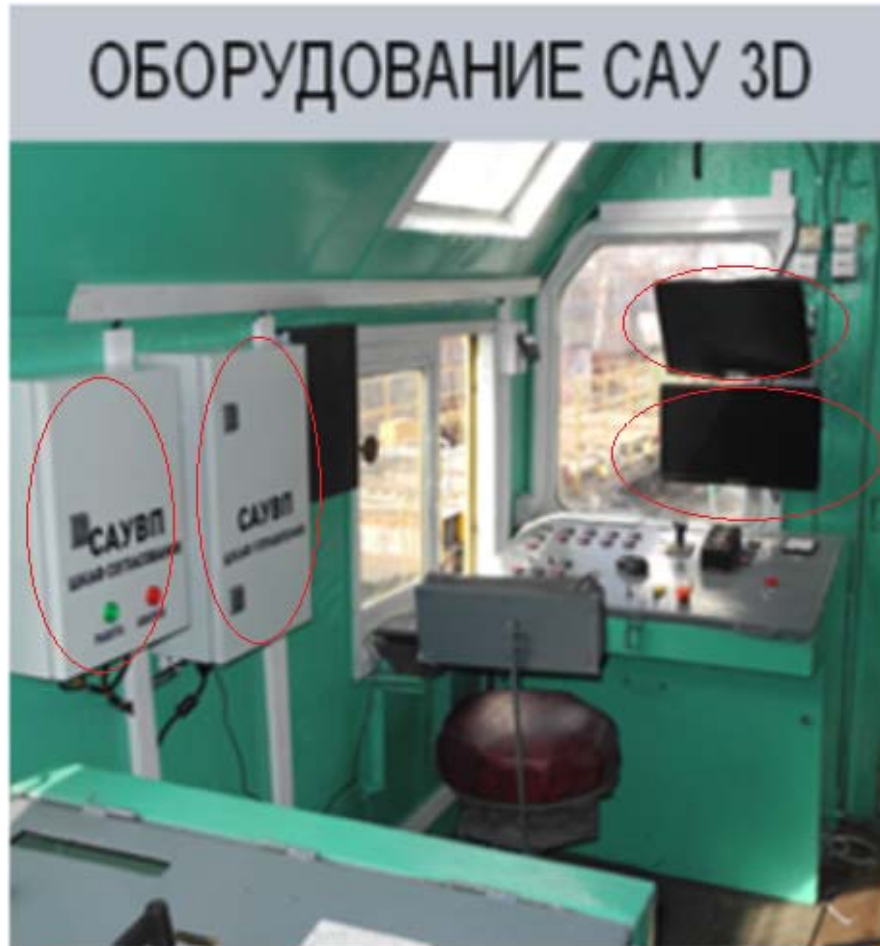
Рисунок 47 – Система автоматизированного управления САУ-3D (ГНСС)
