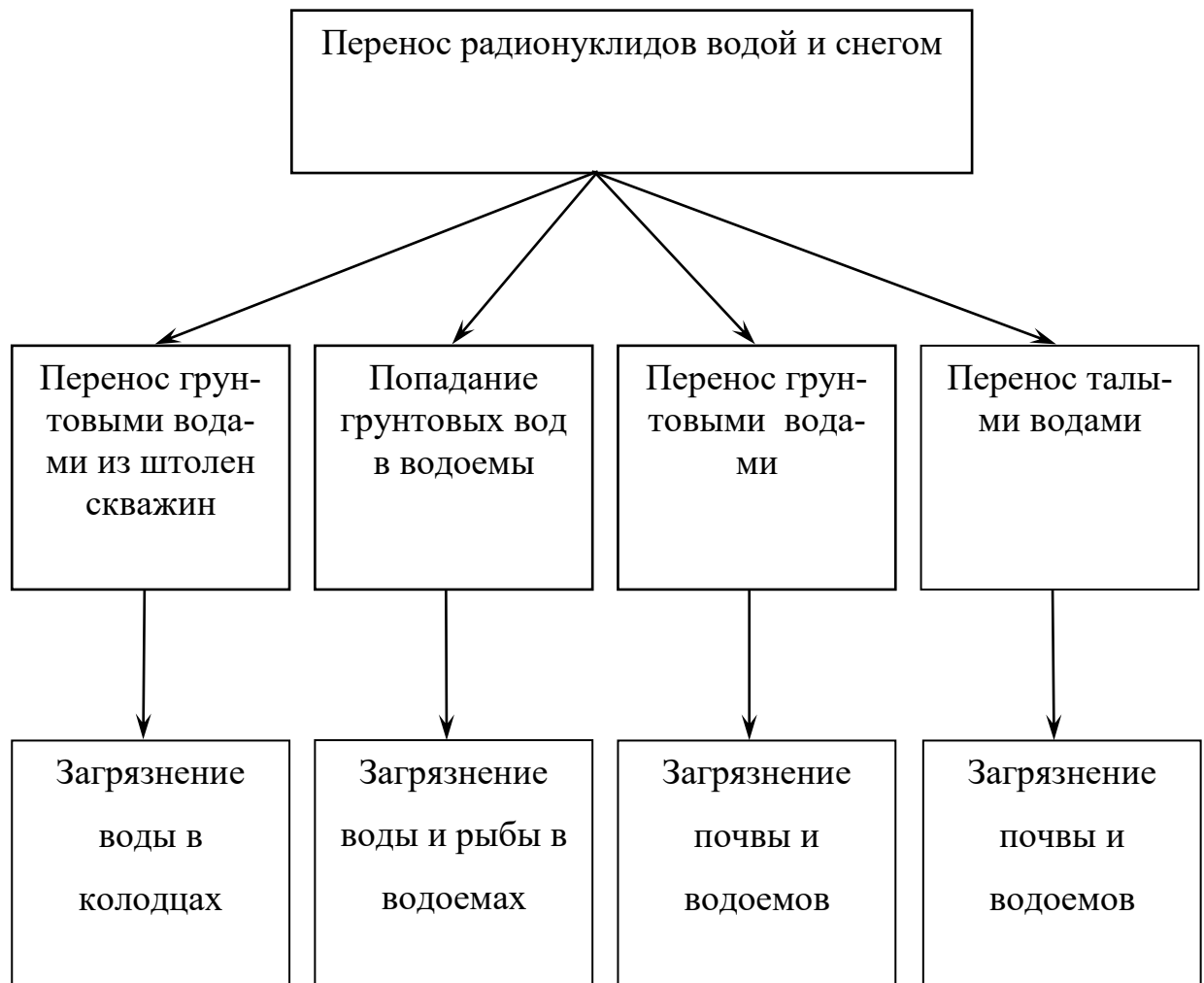
Рисунок 10 – Способы переноса радионуклидов водой и снегом
