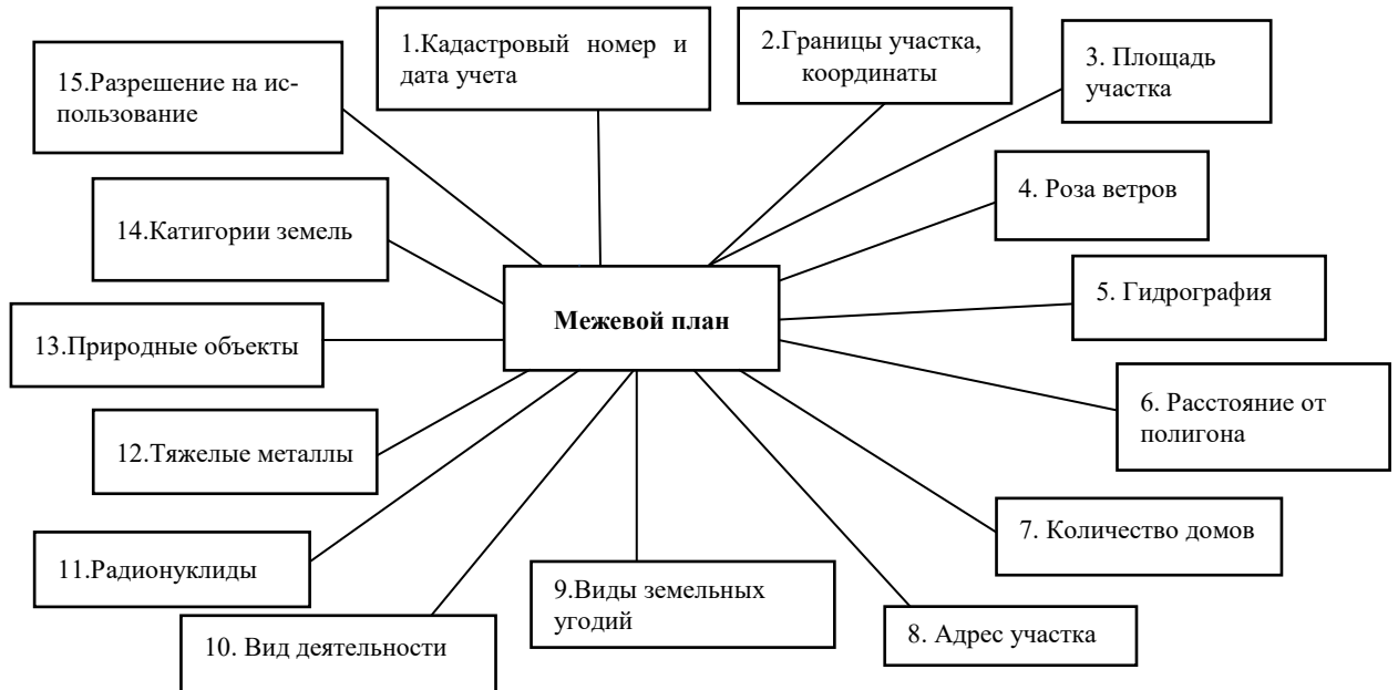
Рисунок 50 – Дополнения к составу межевого плана для земель, загрязненных радионуклидами или тяжелыми металлами
