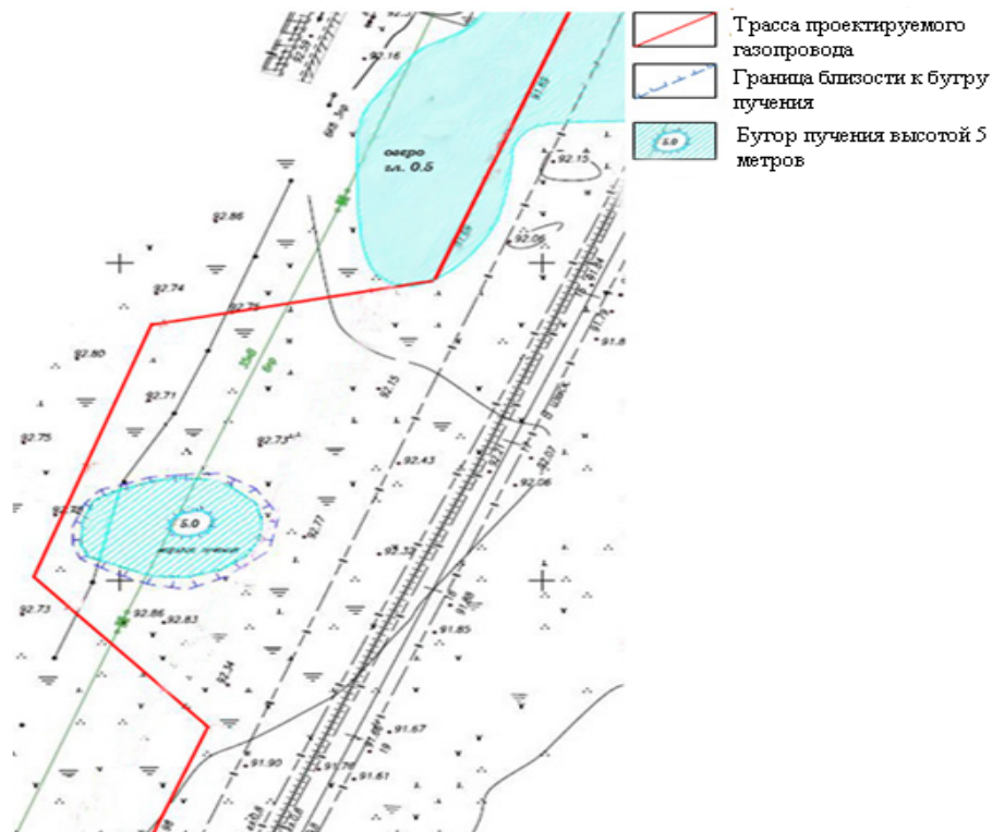
Рисунок 10 – Пример выбора трассы газопровода вблизи бугра пучения «вечной мерзлоты»
