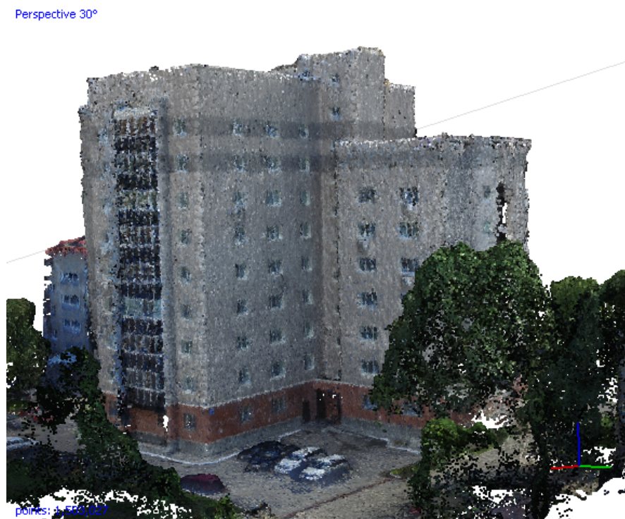
Рисунок 46 – Результат обработки плановой и перспективной аэрофотосъемки в программном комплексе Agisoft Photoscan
