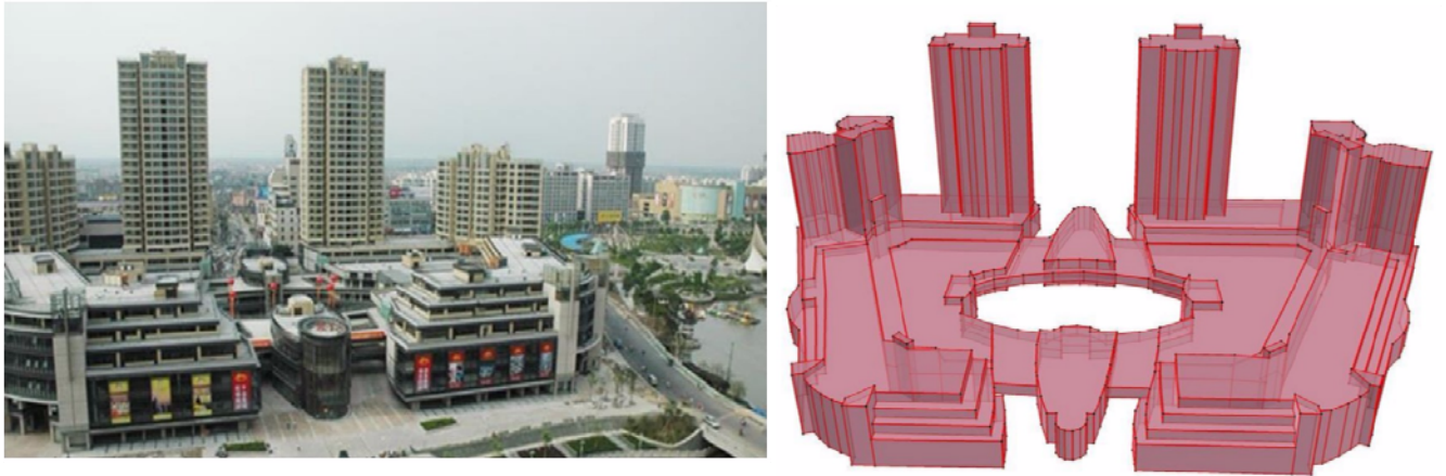
Рисунок 27 – 3D-модель торгового центра, сформированная на основе ограничивающих моделей (Китай)
