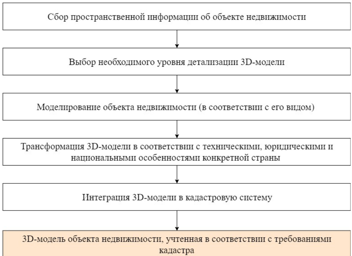
Рисунок 22 – Схема формирования 3D-модели объекта недвижимости
