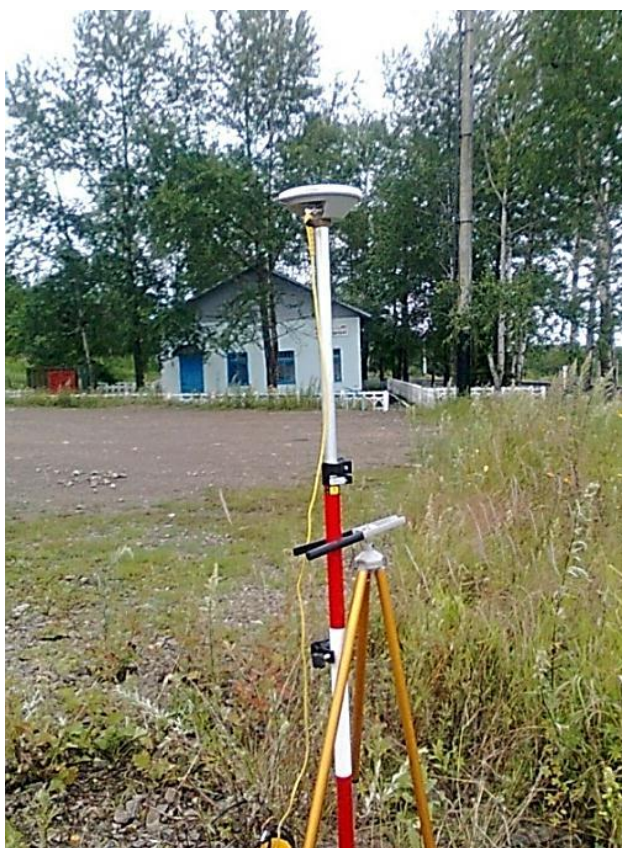
Рисунок 5.8 – GPS-приёмник Trimble 5700 на ст. Ландыши
