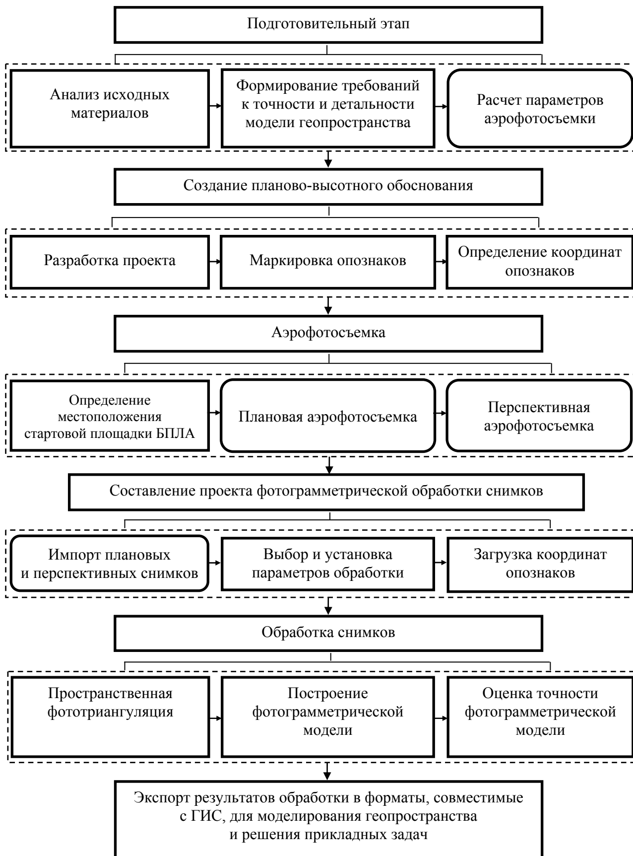
Рисунок 1 – Технологическая схема сбора и обработки данных АФС с использованием БПЛА для моделирования геопространства
