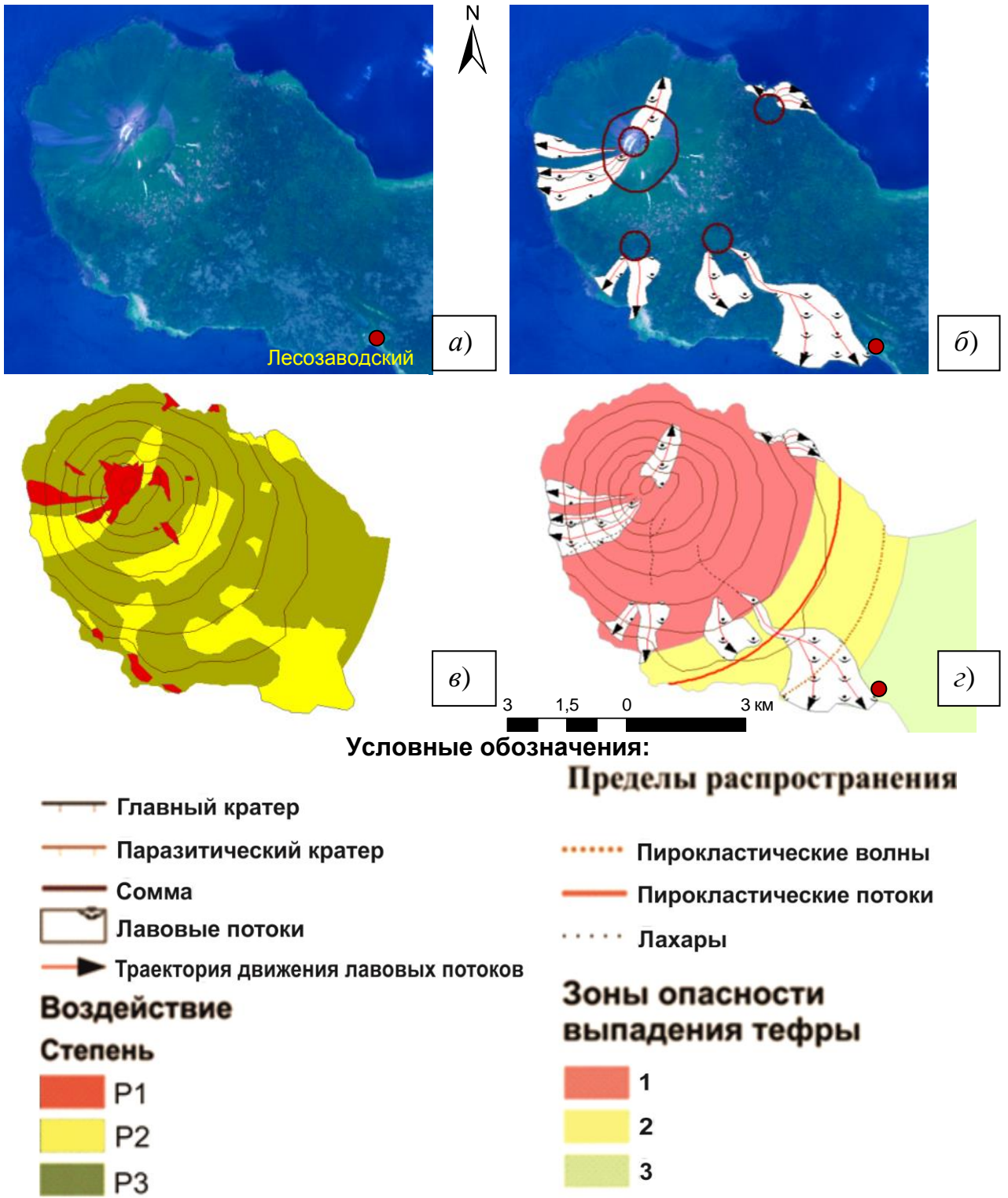
Рисунок 4.9 – Этапы подготовки карт состояния земель и вулканопасности: а) исходный снимок; б) схема дешифрирования; в) картосхема состояния земель; з) зонирование территории по степени вулканопасности
