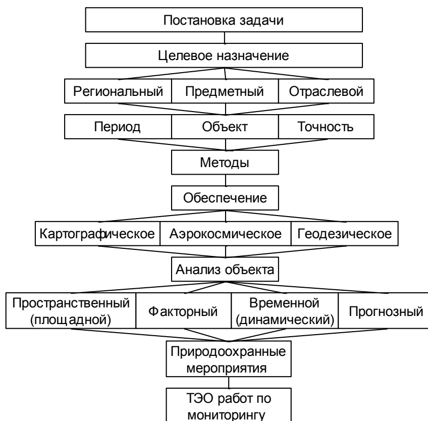
Рисунок 1.2 – Технологическая схема мониторинга природной среды (по Сладкопевцеву С. А.)
