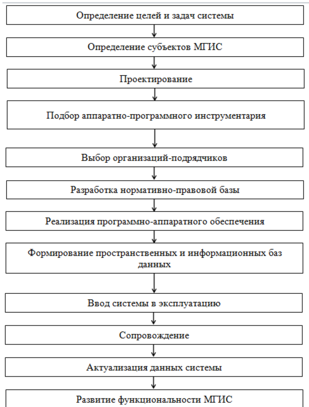
Рисунок 20 – Схема методики создания муниципальных геоинформационных систем
