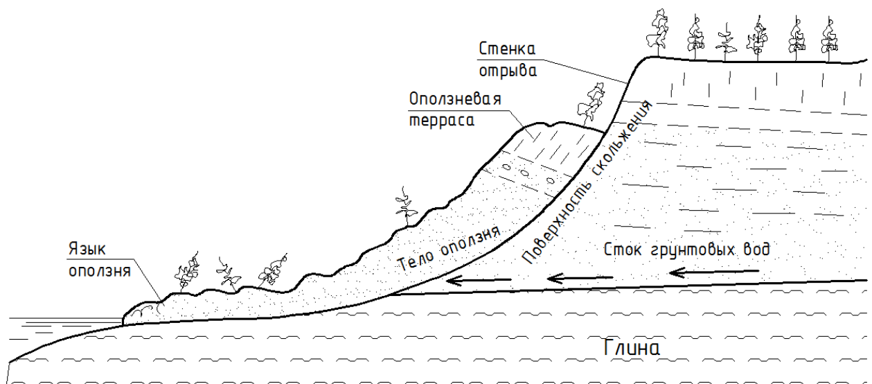
Рисунок 4 – Схема строения оползня
