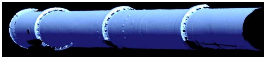
Рисунок 10 – Трехмерная компьютерная модель объекта по результатам лазерного сканирования
