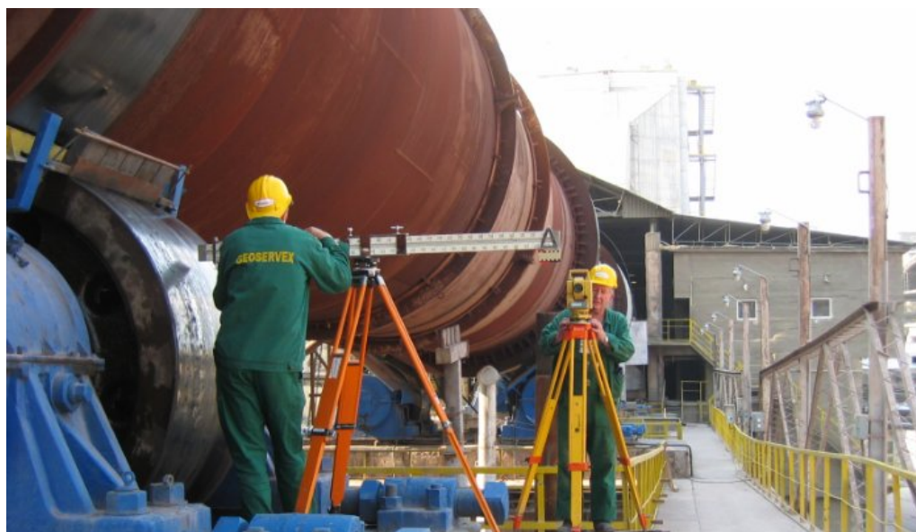
Рисунок 1.4 – Геодезические измерения параметров агрегата по методике Geoservex [114]
