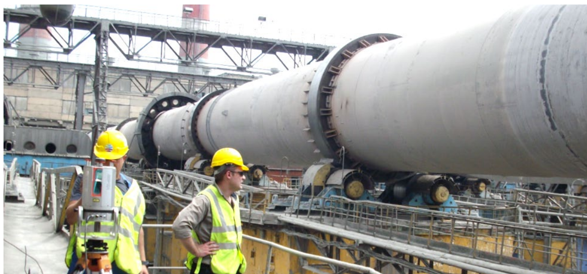
Рисунок 4.22 – Сканирование вращающегося агрегата
