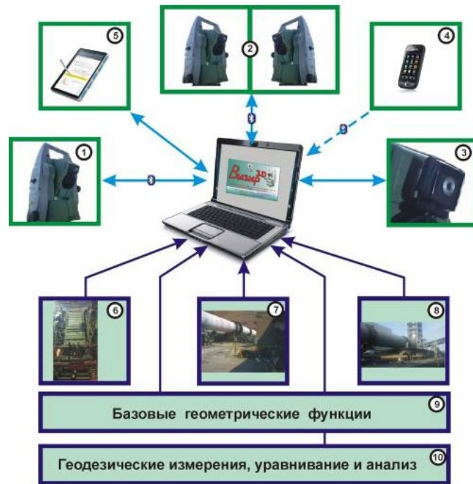
Рисунок 1.6 – Структура программно-аппаратного комплекса «Визир 3D»
