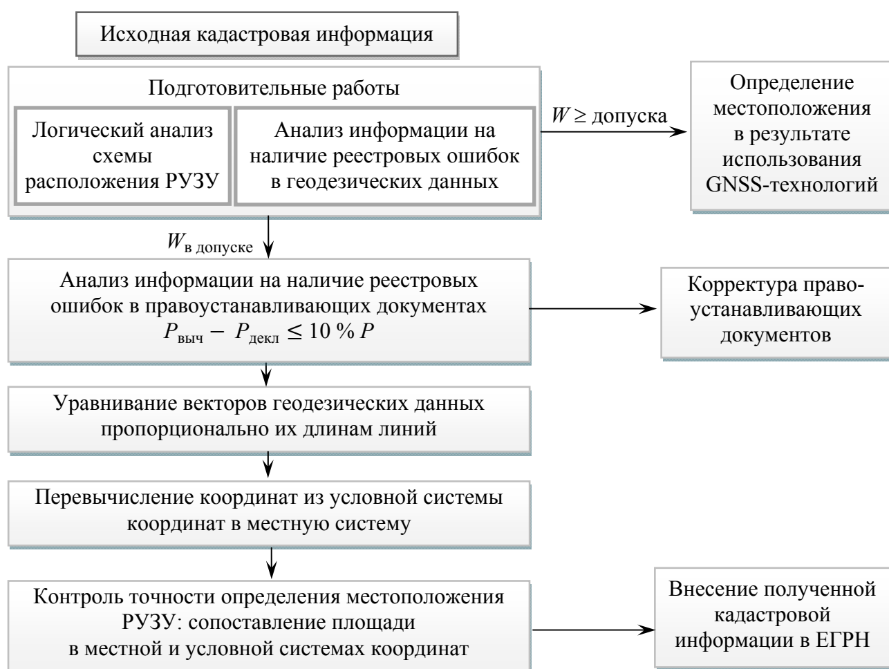
Рисунок 6 – Блок-схема разработанной методики по определению местоположения ранее учтенных земельных участков
