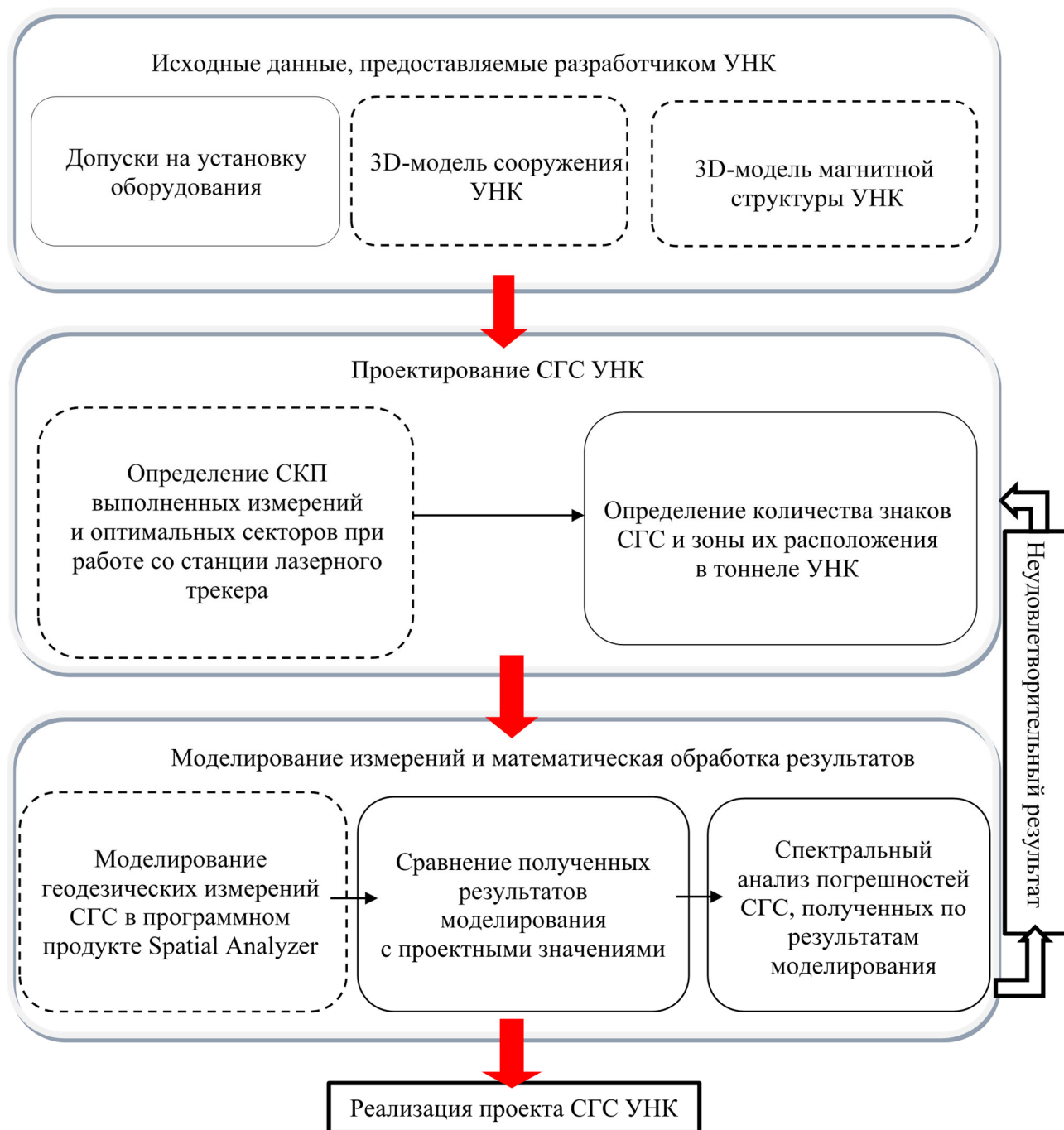
Рисунок 6 – Схема методики геодезического обеспечения для монтажа технологического оборудования источников синхротронного излучения (пунктиром обозначены новые блоки)
