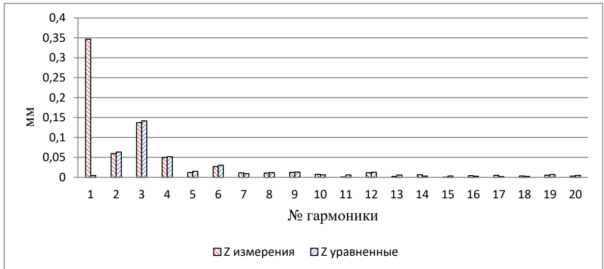
Рисунок 3.29 – График спектрального состава погрешностей измерений знаков сети для вертикального направления варианта сети № 2
