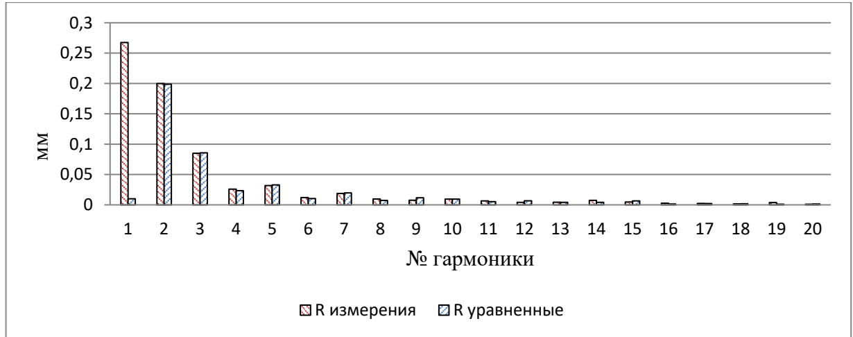
Рисунок 3.28 – График спектрального состава погрешностей измерений знаков сети для радиального направления варианта сети № 2
