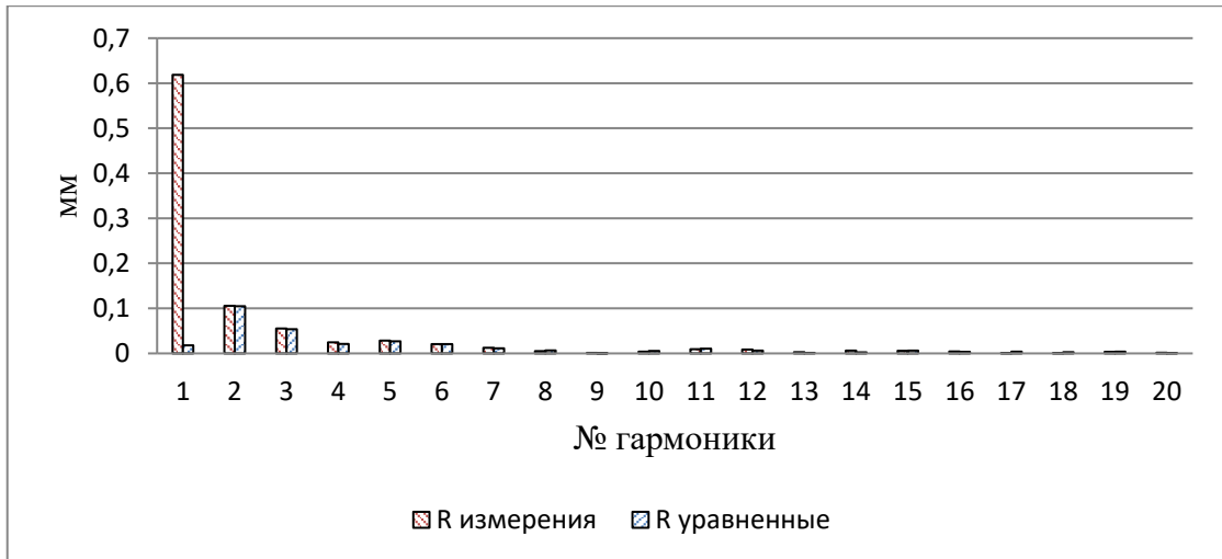
Рисунок 3.31 – График спектрального состава погрешностей измерений знаков сети для радиального направления варианта сети № 3
