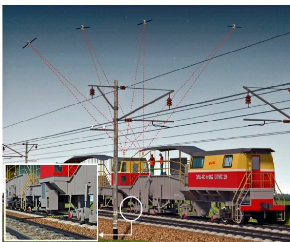
Рисунок 23 – Общий вид электробалластера ЭЛБ-4С ОПМС-19 ЗСДРП, оборудованного двумя САУ-3D
