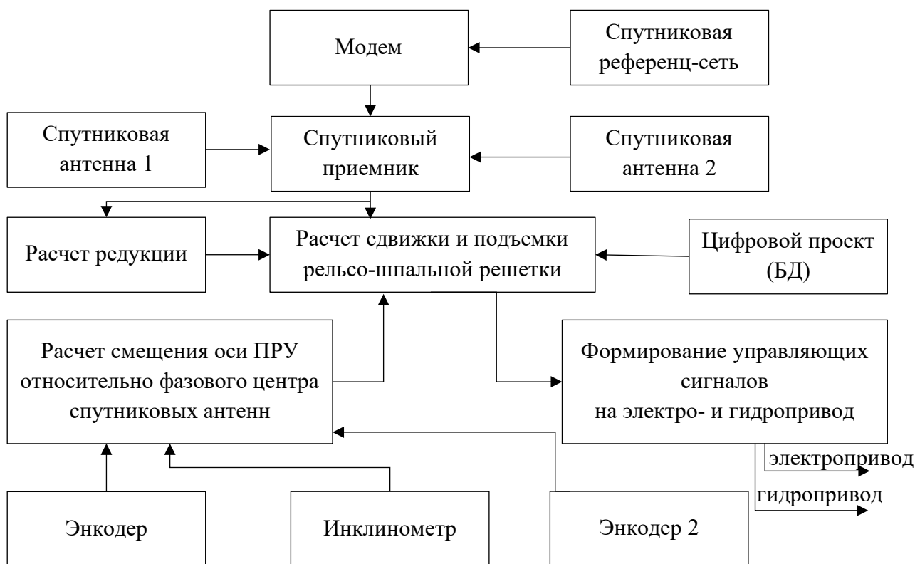
Рисунок 18 – Структурная схема расчета сдвижек, подъемок и формирования управляющих сигналов в САУ-3D для постановки пути в проектное положение
