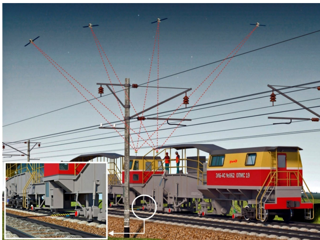
Рисунок 3.26 – Общий вид электробалластера ЭЛБ-4С ОПМС-19 ЗСДРП, оборудованного двумя САУ-3D
