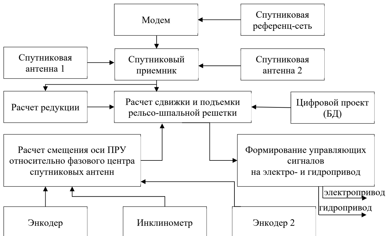
Рисунок 3.20 – Структурная схема расчета сдвижек, подъемок и формирования управляющих сигналов в САУ-3D для постановки пути в проектное положение
