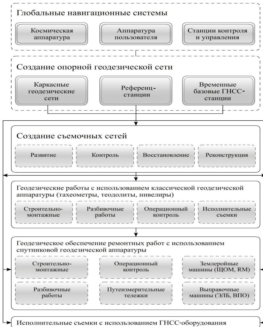
Рисунок 1.1 – Структурная схема геодезического обеспечения реконструкции и ремонта железных дорог с использованием ГНСС и традиционных инструментальных методов
