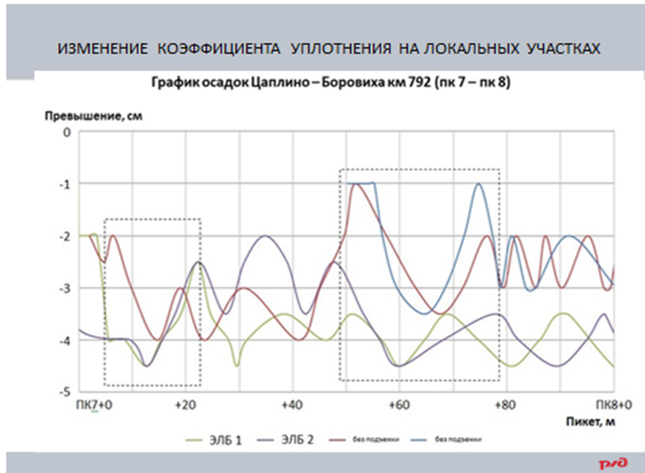
Рисунок 3.18 – График уплотнения балласта при нескольких проходах ДСП на участке Цаплино – Боровиха, 792 км (Пк7-Пк8)
